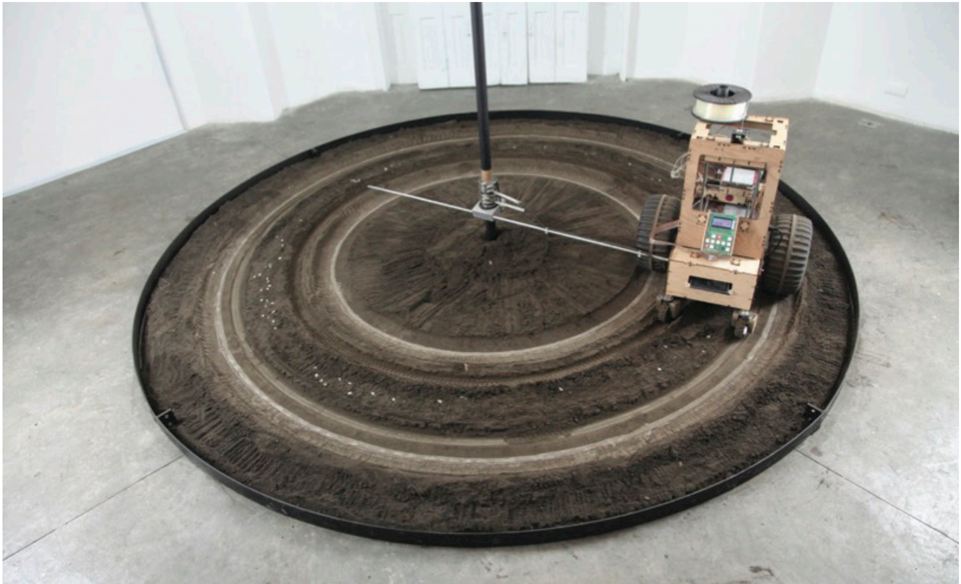
1.5 Armas, Marcela y Constantini Arcángelo (2017). Fotografía. Inspirada por la conflictiva relación entre la economía del maíz basada en el mercado y sus simbólicos y profundos valores culturales en México, Milpa Polímera es una impresora 3D modificada para funcionar como un tractor que planta semillas infértiles hechas de ácido poliláctico, un biopolímero termoplástico producido a partir de una cepa de maíz patentada. La máquina está atrapada en un ciclo perverso y absurdo que contradice los orígenes del maíz: una planta domesticada hace unos 10.000 años por una civilización colectiva cuya cosmogonía y cultura la veían como una fuente compartida de vida. Leonardo, Volumen 50, No.4.
