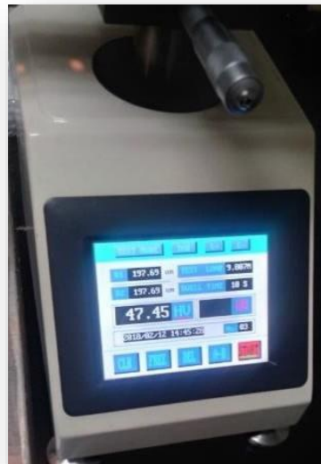
Figura 27. Muestra del resultado de cada bloque de resina compuesta en la pantalla del Microdurómetro modelo SXHV-1000TA (Sinowen; DongGuan, China).
