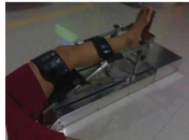
Figura 1.18 Dispositivo de CMP para rehabilitación de rodilla [32].
