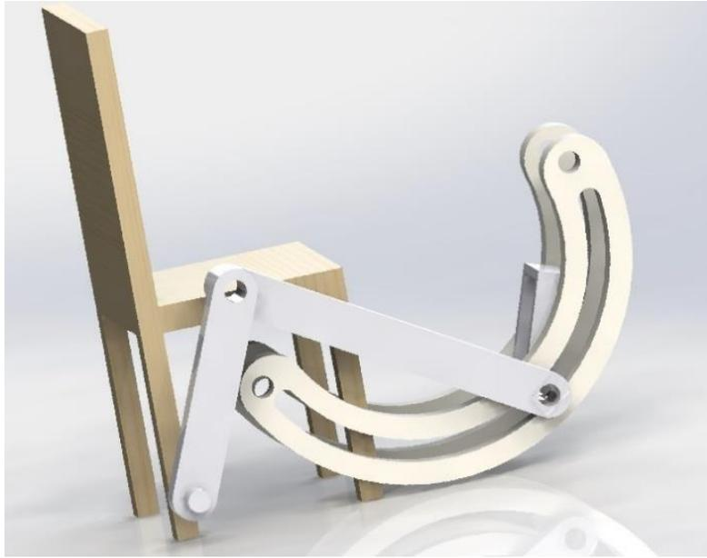
Figura 2.10 Diseño conceptual del mecanismo con corredera curva
