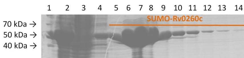
Rycina 5.8. Analiza SDS-PAGE frakcji zebranych podczas oczyszczania białka SUMO-Rv0260c w 12% żelu poliakrylamidowym: (1) wzorzec mas cząsteczkowych, (2) rozpuszczalna frakcja lizatu komórkowego po sonikacji, (3) frakcja białek niezwiązanych do złoża, (4) frakcja pochodząca z płukania złoża, (5-14) frakcje po elucji ze złoża.
