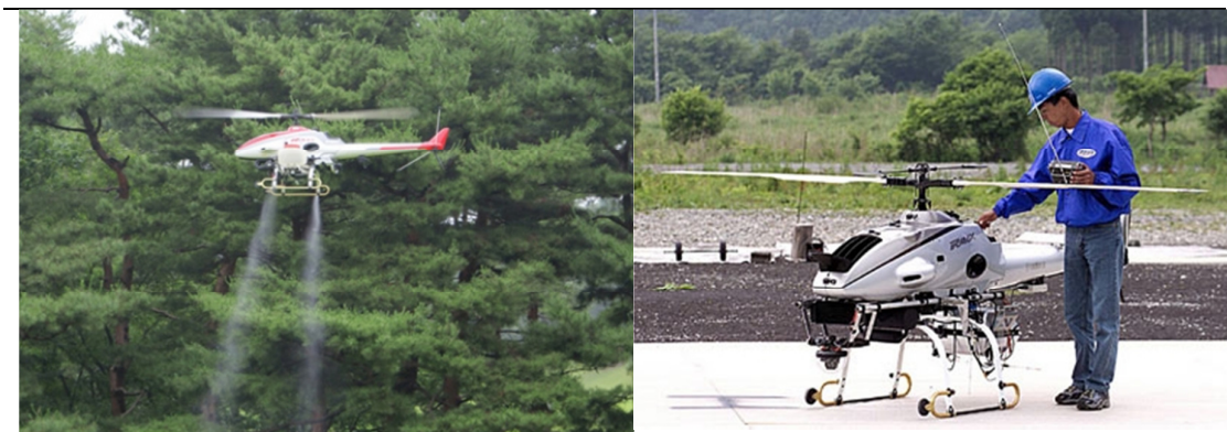
Drone-helicóptero Yamaha RMAX Type II G aplicando fitosanitarios (izquierda), y en tierra (derecha) (Fuente: Yamaha Australia)
