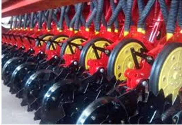
Vamos a explicar esto. Al no aplicarse sobre el suelo, una fuerza vertical de 200 kg por cuerpo de siembra, NO hay una compactación excesiva del suelo, (en el área que pisan las ruedas limitadoras de la profundidad).
