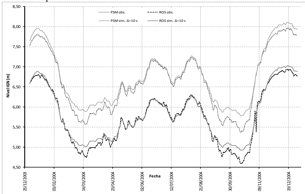
Figura 3.- Perfiles de superficie libre observados y simulados para la serie 01/01/2004 al 31/12/2004 - Constitución M04-06.
