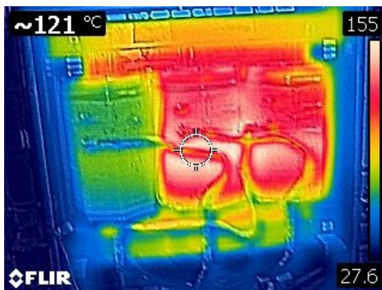
Figura 6. Estudio termográfico transformador edificio C.
