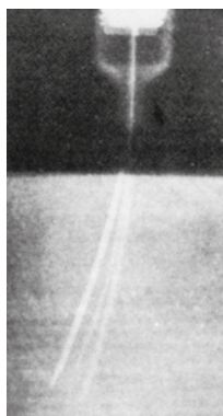
Fig. 7 Radiografía que demuestra los distintos grados de desviación de agujas de calibres diferentes (de izquierda a derecha, 30, 27 y 25). (Reproducida de Malamed S.F: Manual de Anestesia Local , 2. a ed., Barcelona, 2013, Elsevier).
