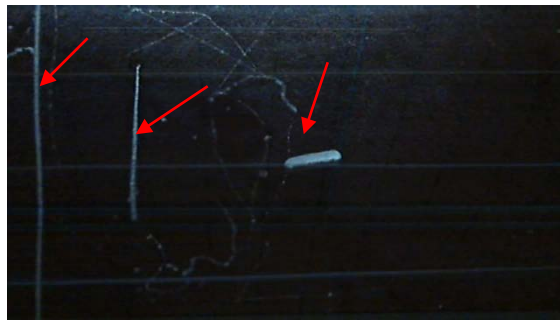
Figura 4.4.- Dos partículas muy energéticas en vertical y una partícula alfa en horizontal fotografiadas en la cámara del IFIC.
