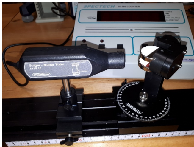
Figura 1.1.- Montaje del laboratorio, con el tubo GM (a la izquierda), el sistema de deflexión (espectrómetro magnético, a la derecha) y la fuente de alimentación/contador conectado vía USB al ordenador de sobremesa (detrás).
