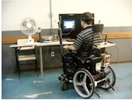
Figura 1 – Controle da cadeira robótica da UFES e do ambiente por movimento dos olhos (por IROG – oculografia por infravermelho).
