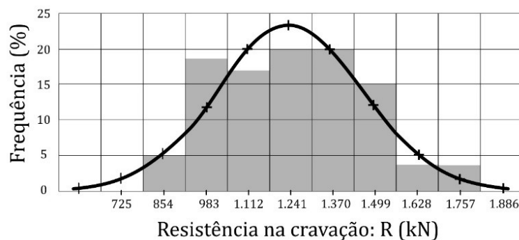
Figura 2.11 – Histograma de aproximação da função densidade de probabilidade para a variável aleatória de resistência
