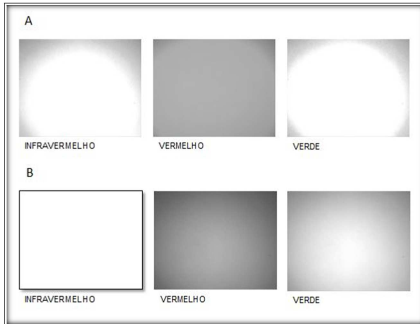
Figura 8: A – Imagem do alvo branco de E.V.A processada com a matrix padrão da câmera. B - Imagem do alvo branco de E.V.A processada com uma matrix simples, sem correção.
