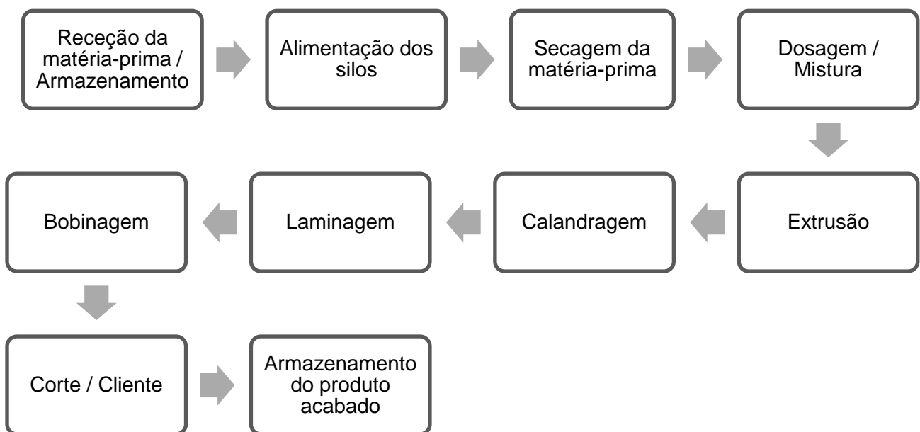
Figura 3.1 – Esquema do processo produtivo
