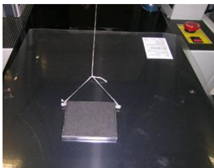
Figura 4.2 – Determinação da força de atrito
