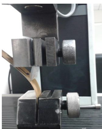
Figura 4.1 – Provette colocado nas garras do dinamómetro
