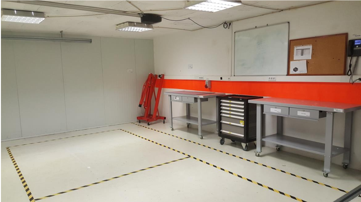
Figura 36 - Área de montagem da oficina de produção (após aplicação dos 5S)
