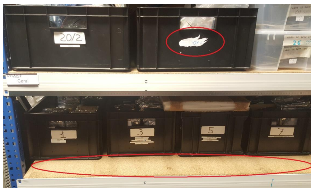
Figura 41 - Etiquetagem defeituosa (cima) e mau aproveitamento das prateleiras (baixo)
