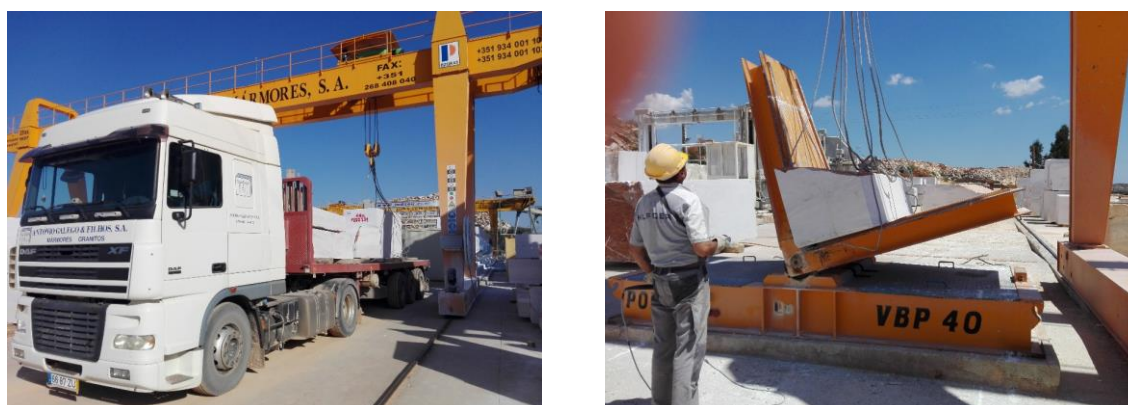
Figura 3-3 - Camião de transporte de bloco, pórticos e o respetivo vira-blocos.
