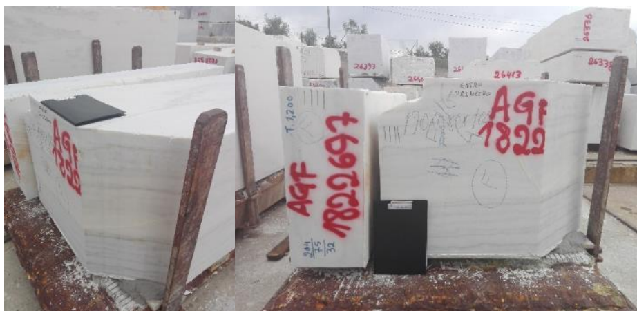
Figura 5-27 - Quantificação do volume final do bloco 1822717 para o cálculo do escombro de mármore.
