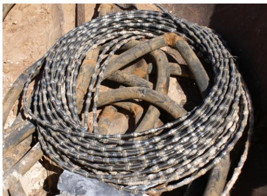
Figura 5-14 - Fio diamantado com cabo de aço e pérolas diamantadas.
