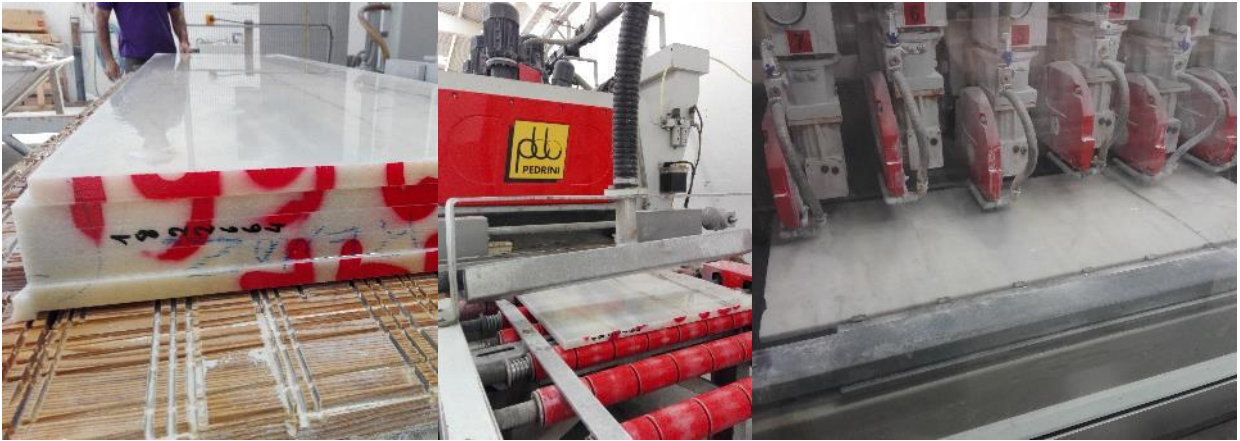
Figura 5-37 - Da esquerda para a direita, palete de 5 bandas na entrada linha de produção de ladrilho, banda na saída do etapa de polimento, produção de ladrilhos através do corte de bandas com recurso discos diamantados.
