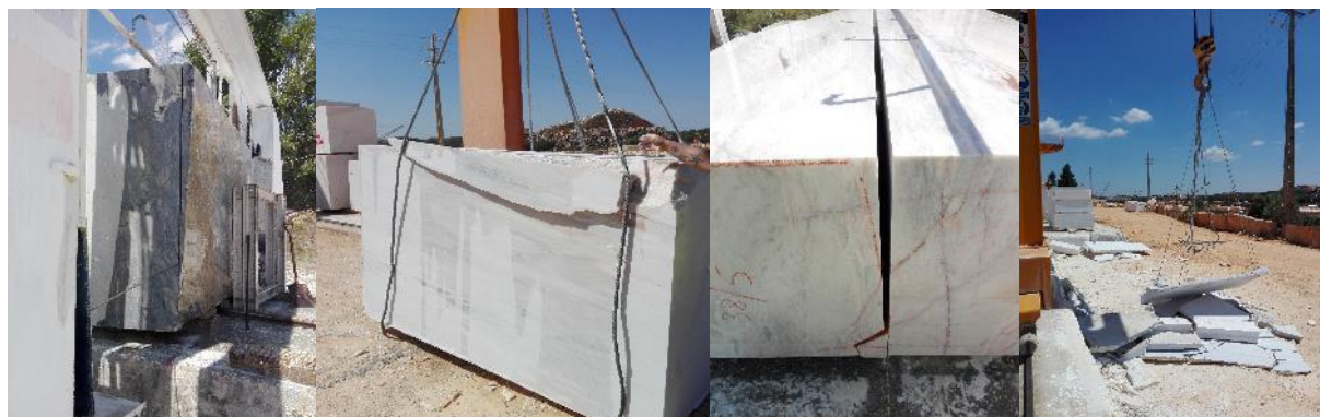
Figura 5-24 - Corte de bloco na linha dos monofios e exemplos de produção e transporte de resíduos de mármore.
