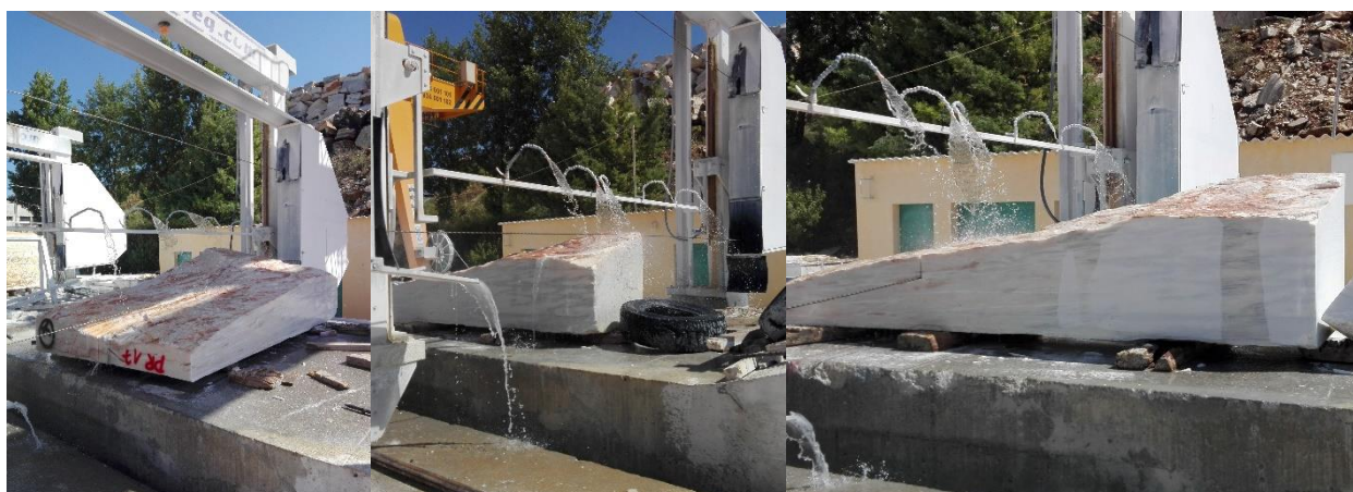
Figura 5-21 - Terceiro, quarto e quinto corte aplicados no bloco EXT4 na linha dos monofios.
