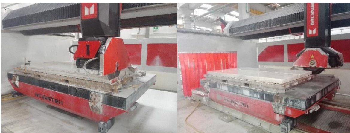
Figura 5-35 - Máquinas de corte de chapas na linha de produção de bandas, modelo Monster 1 à esquerda e o modelo Monster 2 à direita.
