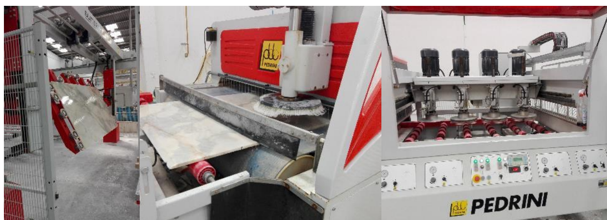
Figura 5-33 - Carregamento de uma chapa com sistema de ventosas, setor de polimento das chapas e etapa de enceramento da chapa.
