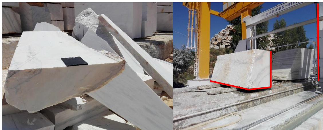
Figura 5-19 - Exemplo da aplicação da técnica de esquadria aos rejeitados de mármore e aos blocos nos monofios.
