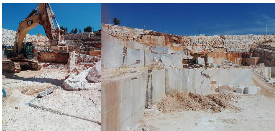
Figura 5-13 - Ferramentas tomba bancadas e riper usados em operações de derrube de talhadas.
