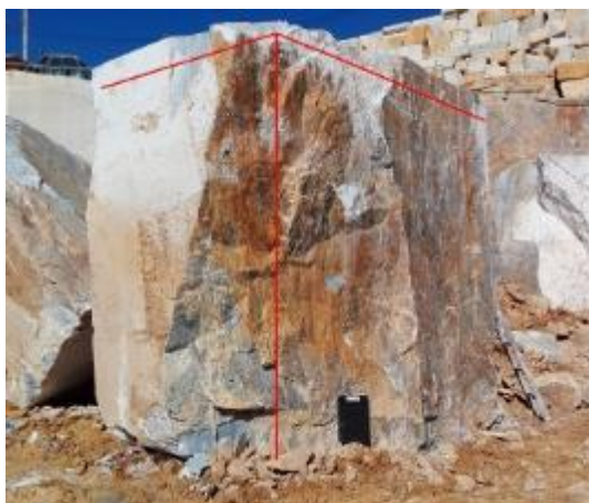
Figura 5-16 - Metodologia de esquadria no cálculo de dimensões dum bloco de mármore com a respetiva escala.
