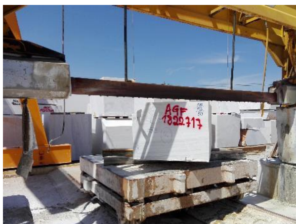
Figura 5-26 - Bloco AGF 1822717 a ser aparelhado na monolâmina.
