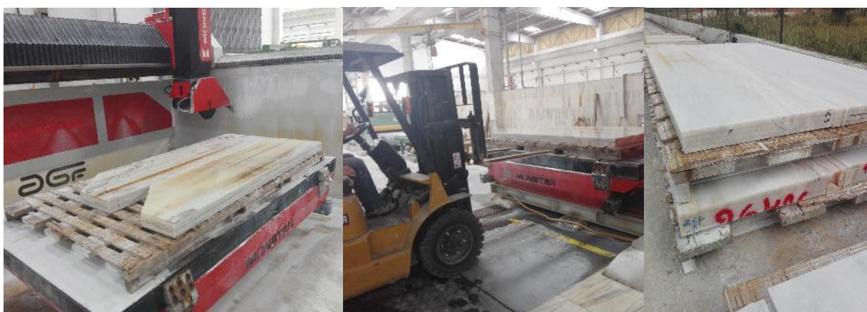
Figura 5-36 - Processo final de corte da chapa em banda e o respetivo carregamento e transporte da banda até ao parque de bandas.
