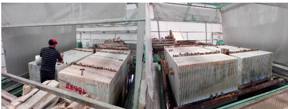
Figura 5-31 - Operação de introdução de cunhas nos blocos de mármore no sector de engenhos multilâminas.
