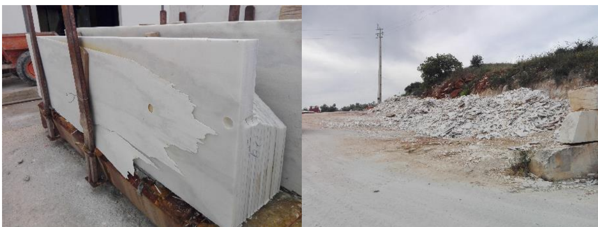
Figura 5-32 - À esquerda, exemplo de uma lasca de mármore que não foi possível se transformar em chapa nos engenhos multilâminas e à direita a escombreira de rejeitados de mármore.
