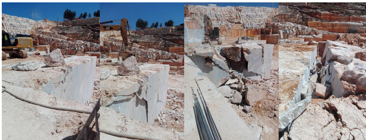
Figura 5-12 - Várias etapas de derrube duma talhada.
