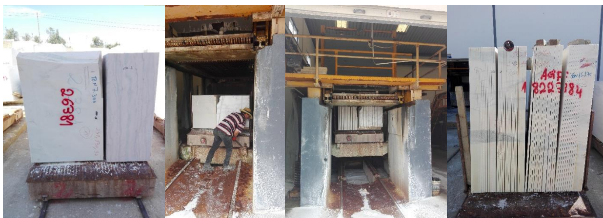
Figura 5-29 - Transporte, encaixe e ajuste e a serragem do bloco. Mais à direita o bloco agora em chapas.
