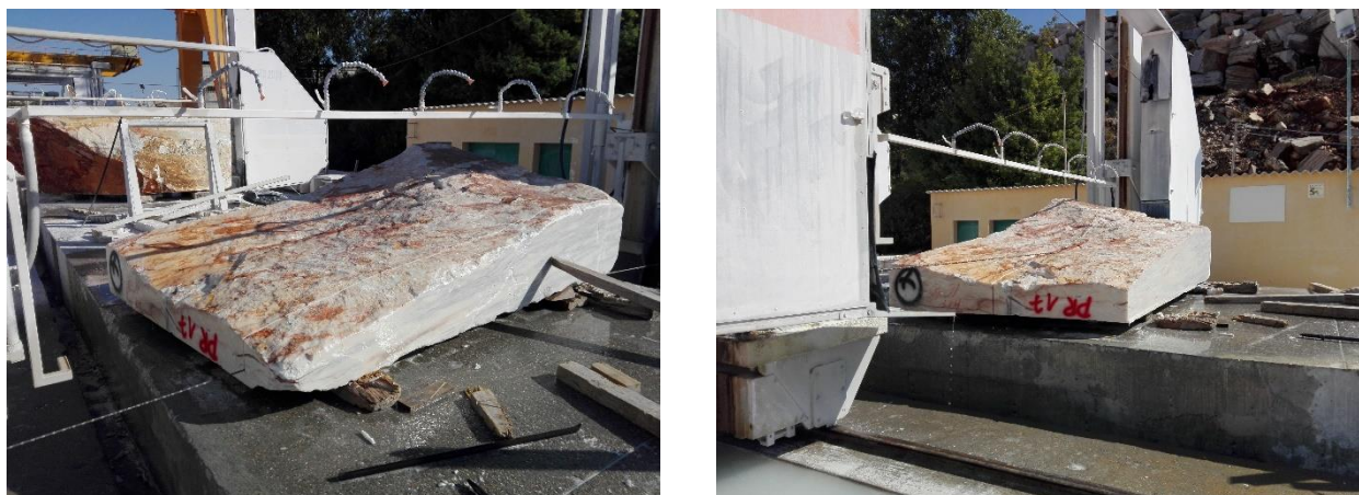
Figura 5-20 - Primeiro e segundo corte aplicados no bloco EXT4 na linha dos monofios.
