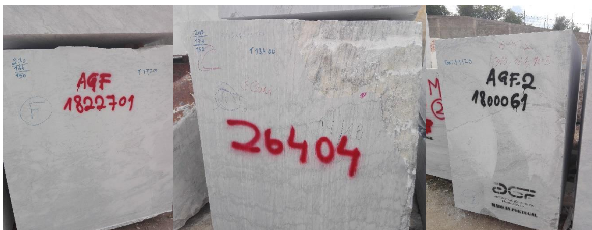
Figura 5-25 - Exemplos dos vários códigos definidos nos blocos de mármore que pertencem à empresa AGF.
