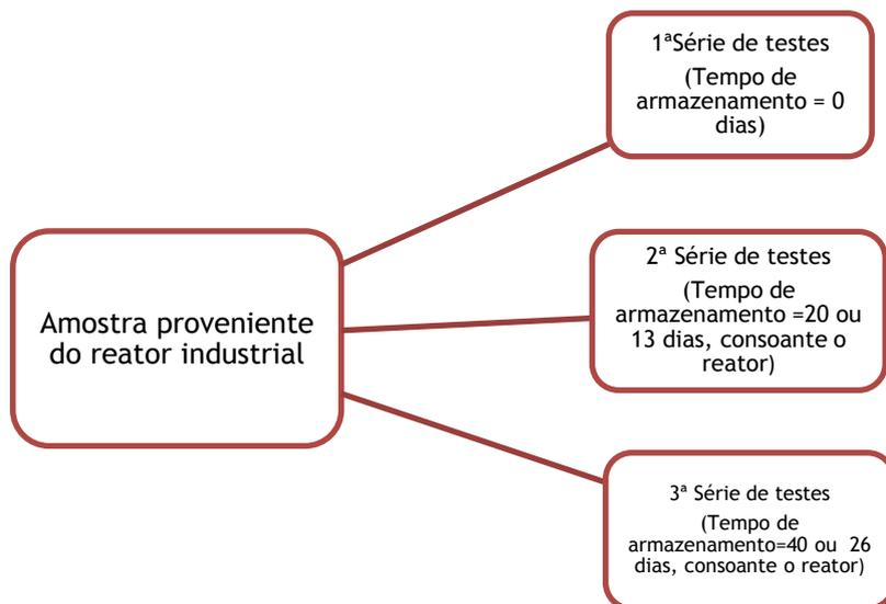
Figura 3.3 - Planeamento do armazenamento de amostras e realização de testes catalíticos.
