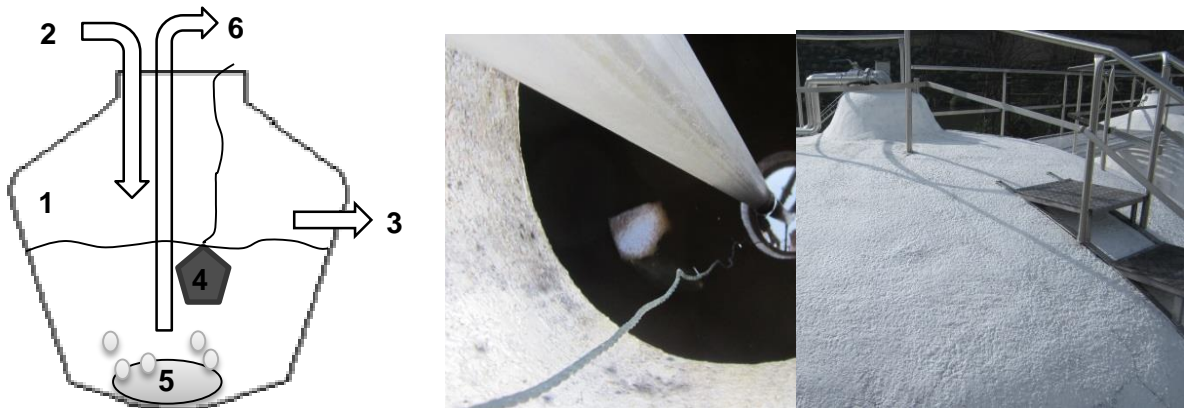
Figura 16 – Esquema do reator SBR vinícola onde os suportes foram colocados a colonizar. Legenda: 1 – Reator do tipo SBR; 2 – Entrada do efluente; 3 – Saída do efluente; 4 – Suportes para colonização dentro dos sacos; 5 – Arejamento; 6 – Saída de lamas para recirculação. À direita - fotografias do reator do tipo SBR onde foram colocados os suportes.
