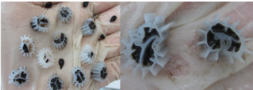
Figura 27 – Suportes BF9 colmatados e presença de grainhas.
