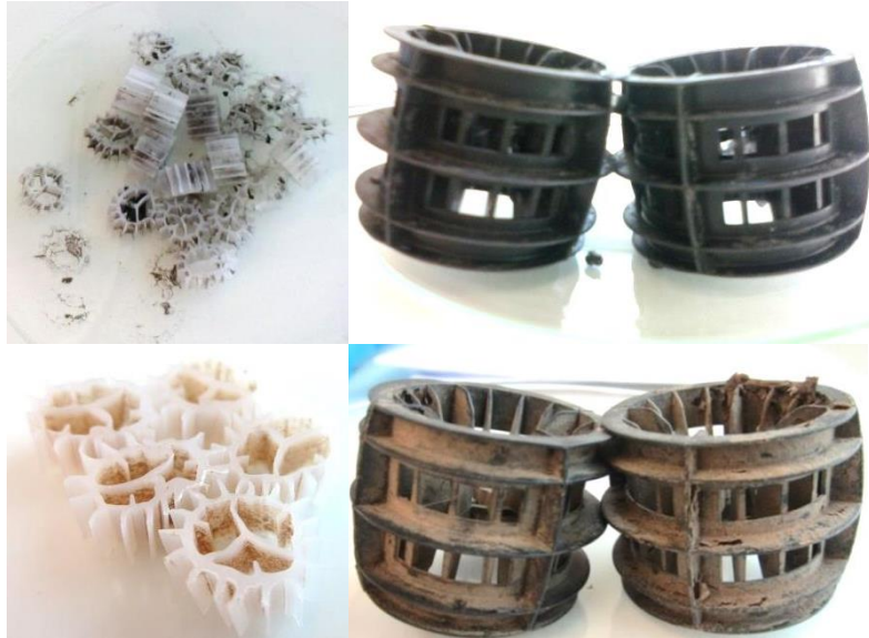
Figura 25 – Imagens dos suportes após secagem em estufa no final do ensaio. Em cima os suportes colonizados na ETAR e em baixo os suportes colonizados no laboratório.
