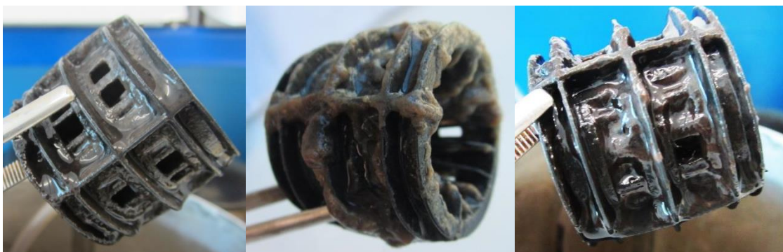
Figura 42 – Espessura e coloração de biofilme ao longo das 16 semanas de operação do reator SBBR B, da esquerda para a direita, sendo as imagens correspondentes ao fim de cada regime (I, II e III, respetivamente).
