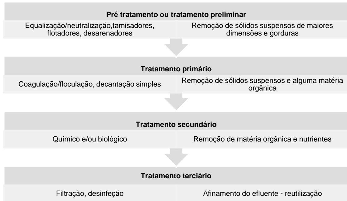
Figura 2 - Esquema dos níveis de tratamento dos efluentes, com exemplos dos tratamentos à esquerda e suas funções à direita.
