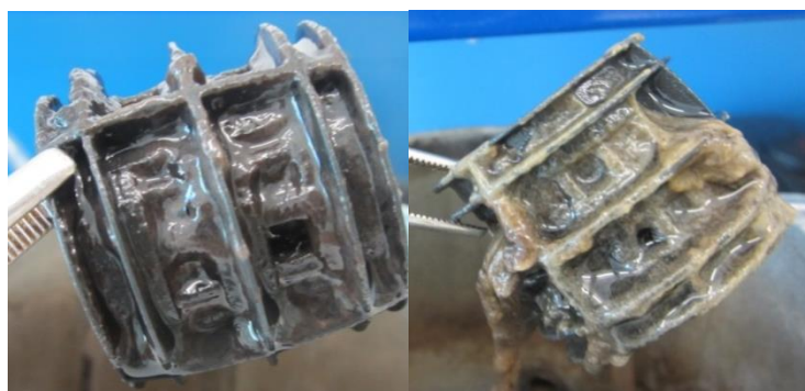
Figura 40 – Espessura do biofilme nos suportes BF 40 do reator SBBR A à esquerda, e do reator SBBR B à direita, antes da operação de lavagem (passagem por efluente bruto decantado).
