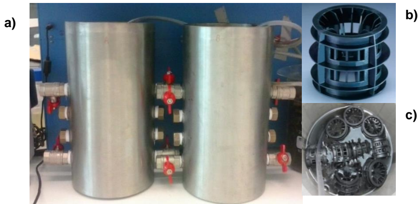
Figuras 22 - a) – Reatores do tipo SBBR usados, preenchidos com suportes BF40 b) e vista de cima c).
