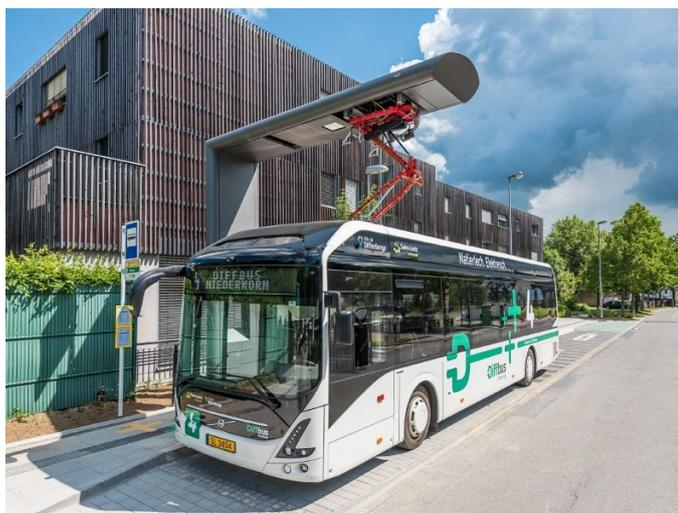
Figura 2.15: Exemplo de uma paragem de autocarro com um sistema de carregamento baseado num pantógrafo [53]
