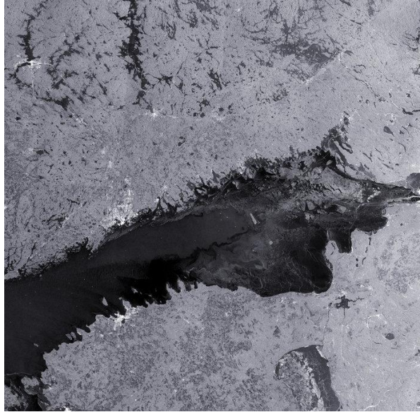
Figura 24 - Imagem de amplitude (Golfo da Finlândia em 8-2-2017). Os aglomerados de reflexos de radar brancos e brilhantes em toda a imagem representam cidades, entre as quais Helsínquia na margem superior do Golfo. Fonte: ESA.
