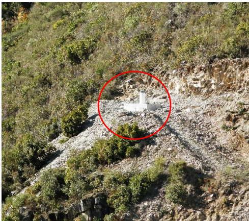
Figura 1 - Ponto de Referência materializado por pilar. Fonte: Própria.
