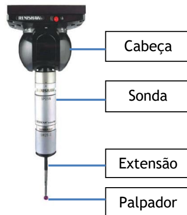
Figura 4 - Sistema de sondagem [25].
