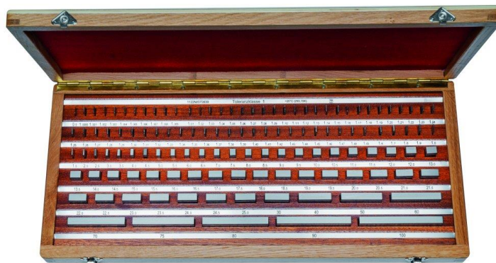
Figura 3 - Blocos-padrão classe K em aço temperado [14].
