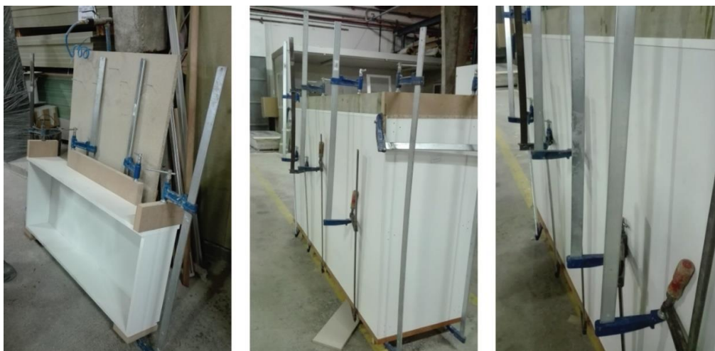
Figura 3 - Pré-montagem de uma gaveta com recurso a cavilhas, cola e grampos.
