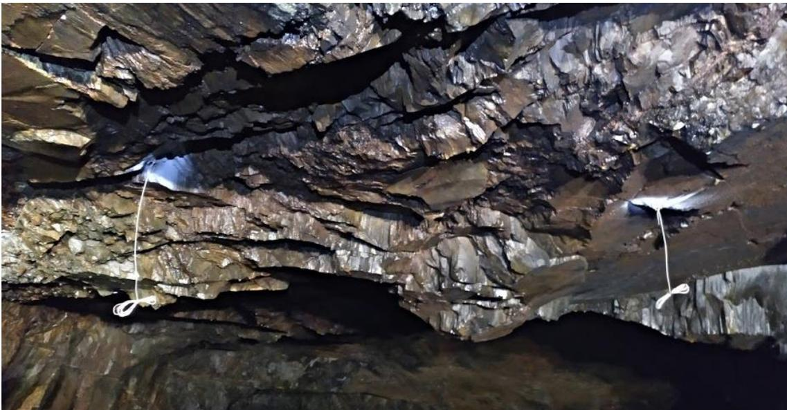
Figura 4-1 - Pontos de identificação do eixo de uma galeria. Fonte: O autor.
