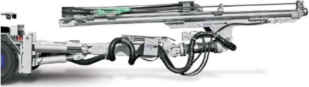
Figura 5-9 - Braço do jumbo da Mine Master. Fonte: Catálogo Mine Master.
