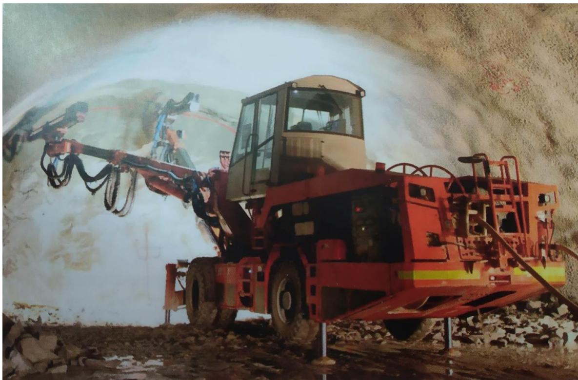
Figura 2-17 - Jumbo em trabalhos de perfuração com cabine elevada e estabilizado com os 4 macacos hidráulicos (Sandvik). Fonte: Aptado de López Jimeno et. al, 2017.
