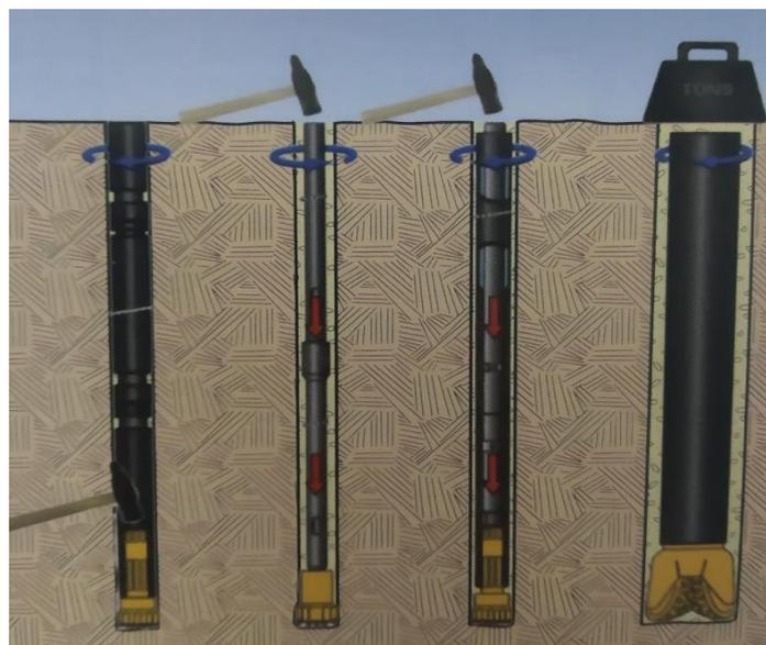
Figura 2-3 - Ações básicas dos métodos rotopercussivos e a rotação com tricornes.
