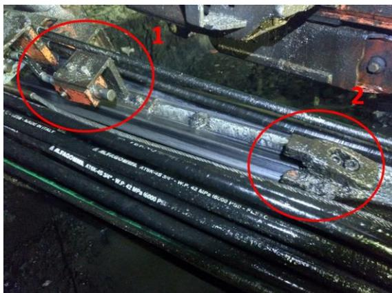
O botão (1) quando pressionado pela peça (2) aciona o sistema automático de retirada da vara e do bit.
