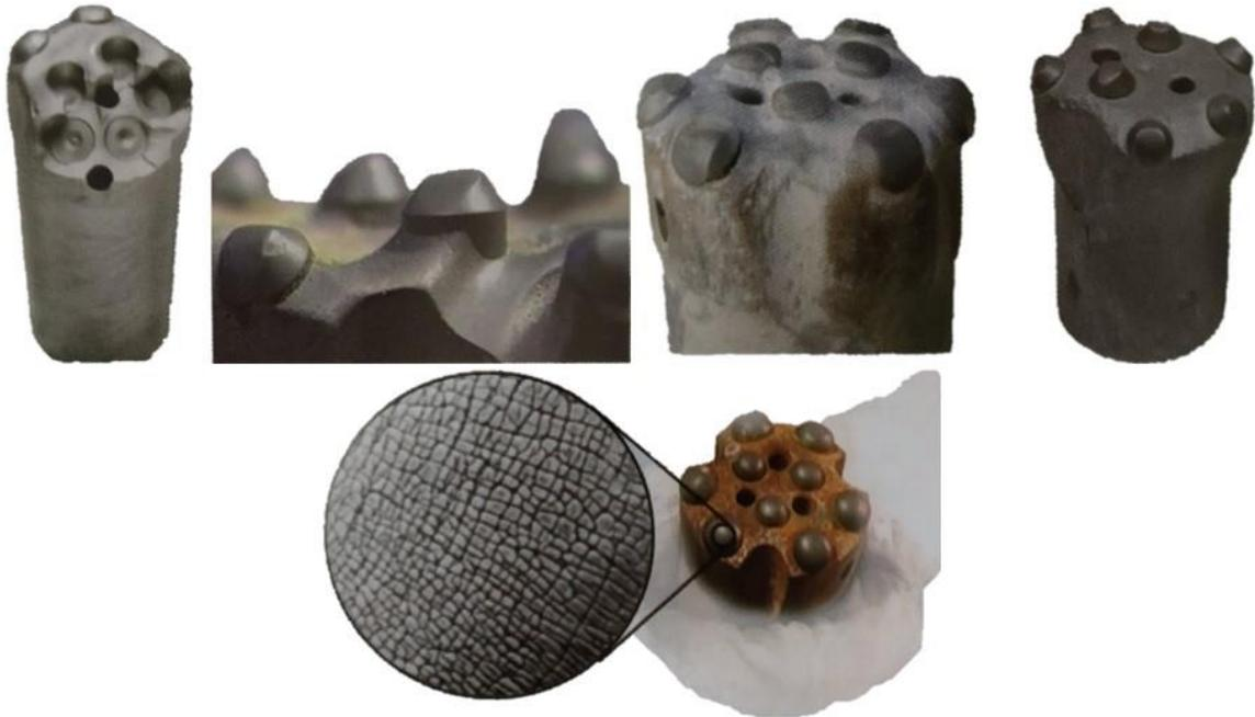
Figura 2-26 - Exemplos de botões e bits desgastados. Fonte: Fonte: López Jimeno et. al, 2017.
