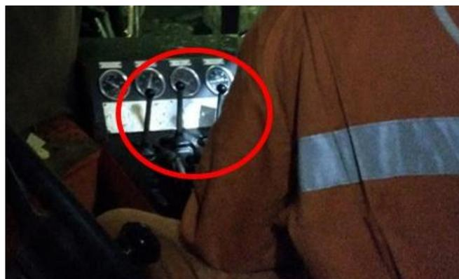
Figura 5-6 - Comandos para controlo do braço de perfuração do jumbo da Sandvik. Fonte: O Autor
