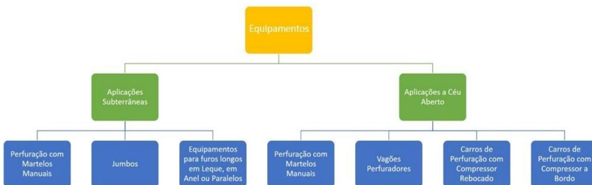
Figura 2-15 - Equipamentos de Perfuração. Aptado de López Jimeno et. al, 2017.
