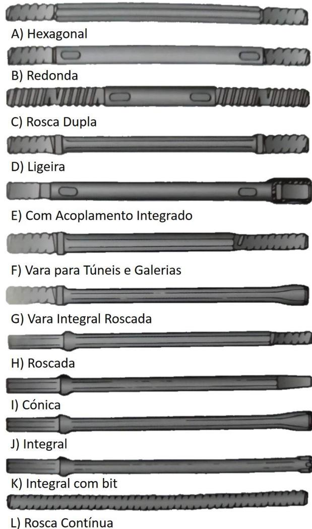
Figura 2-24 - Tipos de varas. Aptado de López Jimeno et. al, 2017.
