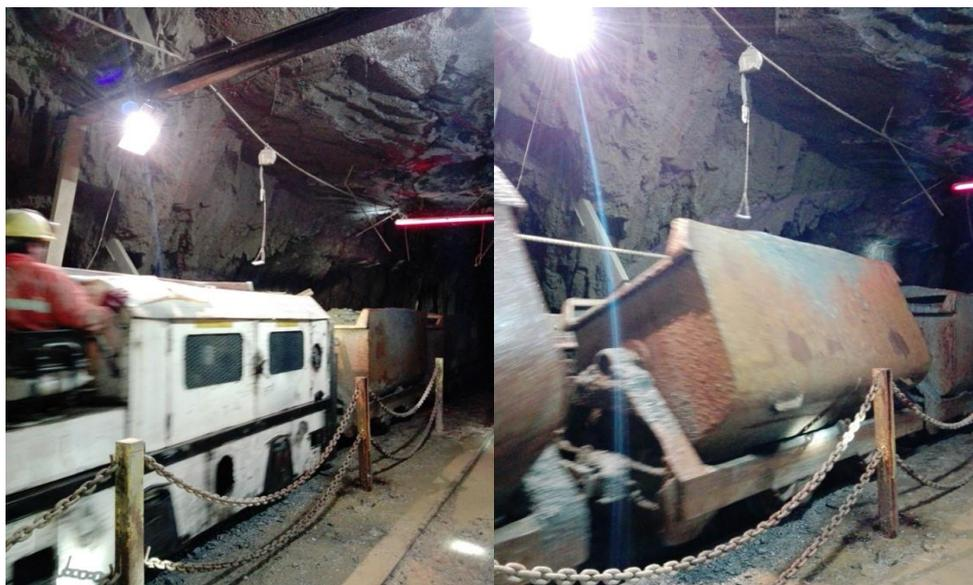
Figura 4-8 - Composição de vagões e respetiva locomotiva (à esquerda) e vagões a descarregarem material para a torva principal de minério (à direita). Foto: Tiago Ferreira.
