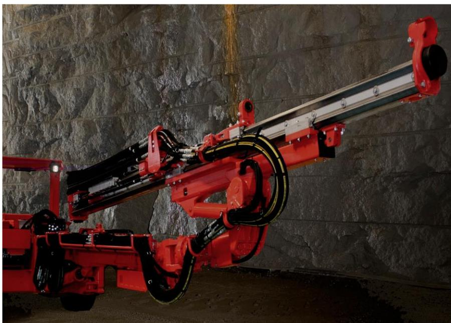
Figura 5-8 - Braço do jumbo da Sandvik. Fonte: Catálogo Sandvik.
