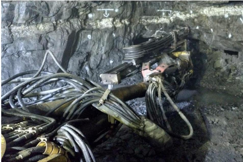
Figura 5-7 - Braço de um dos jumbos da Epiroc. Fonte: O Autor.
