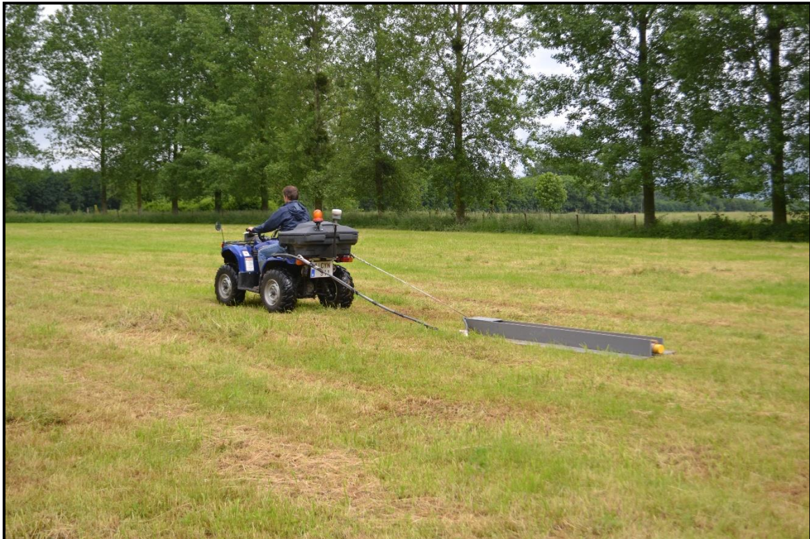
Figuur 17: Mobile sensorconfiguratie met de EMI sensor in de slede en RTK-GPS.
