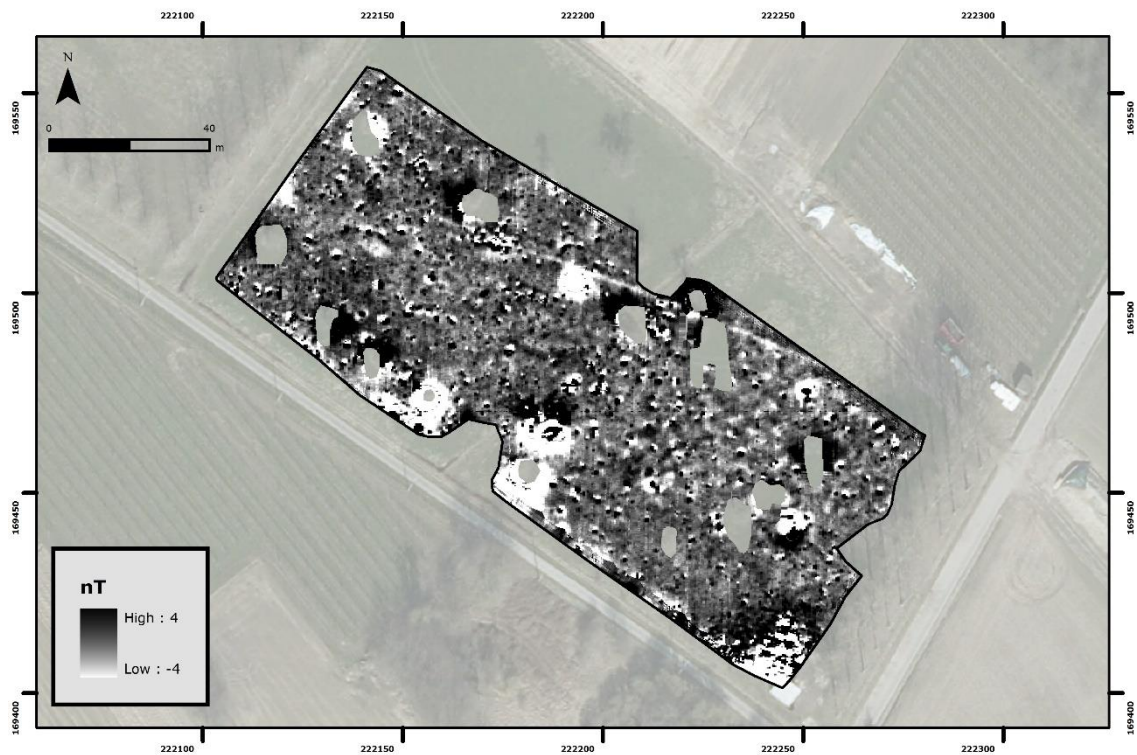
Figuur 49: Magnetische afwijkingen opgemeten met fluxgate magnetometrie (veld B) (212G2).
