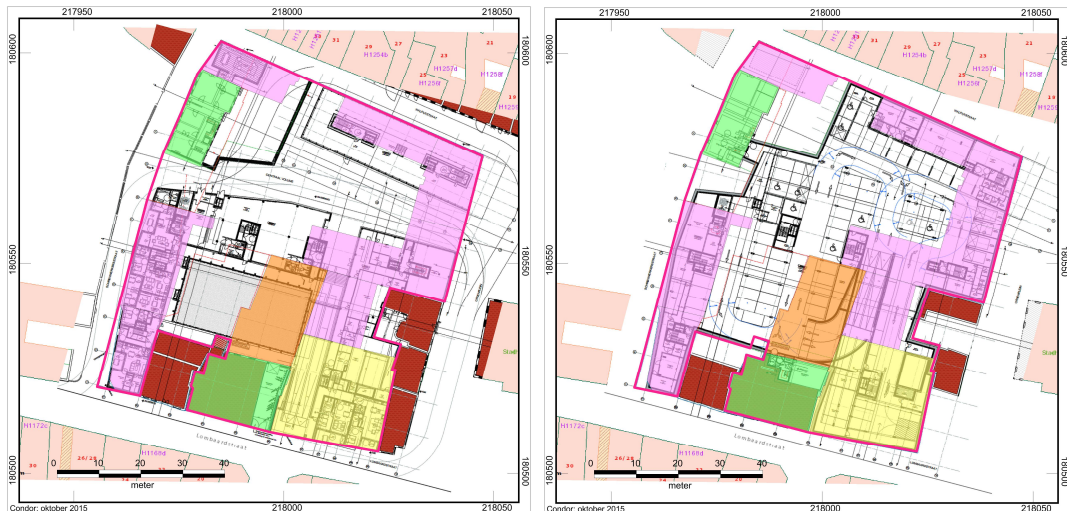
Afbeelding 23: Overzicht de toekomstige ontwikkeling bovengronds (links) als ondergronds op -1 (rechts) als de aanwezige kelders, de ondergrondse parkeergarage en de niet te slopen delen. Groen zal hierbij behouden worden, oranje alludeert op de aanwezige ondergrondse diepe parkeergarage en de roze zones duiden op de ondergrondse diepe keldervertrekken van de schoolinfrastructuur.
