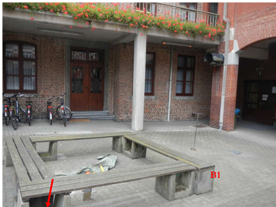
Afbeelding 1: De locatie van boring 1 in een mechanisch boorgat voor een peilbuis en technisch gestaakte eerste poging (rode pijl).
