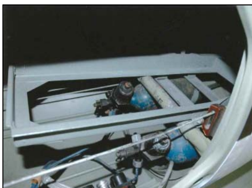
Figuur 54: Twee persluchtflessen voor MG17-Machinegeweren in de romp van een Me 109 50
