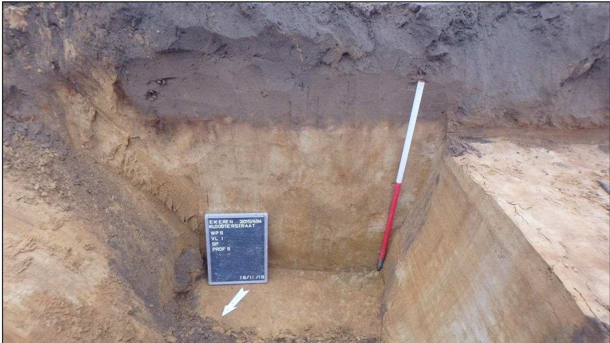
Figuur 13: Bodemprofiel: moederbodem, restanten van een ijzerpodzol, een humus A-horizont en een ophogingslaag
