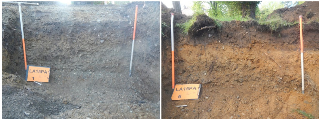
Afbeelding 11: De profielen 3.2 en 1-3 met grinden en grof zand van het Terras van Maasmechelen.
