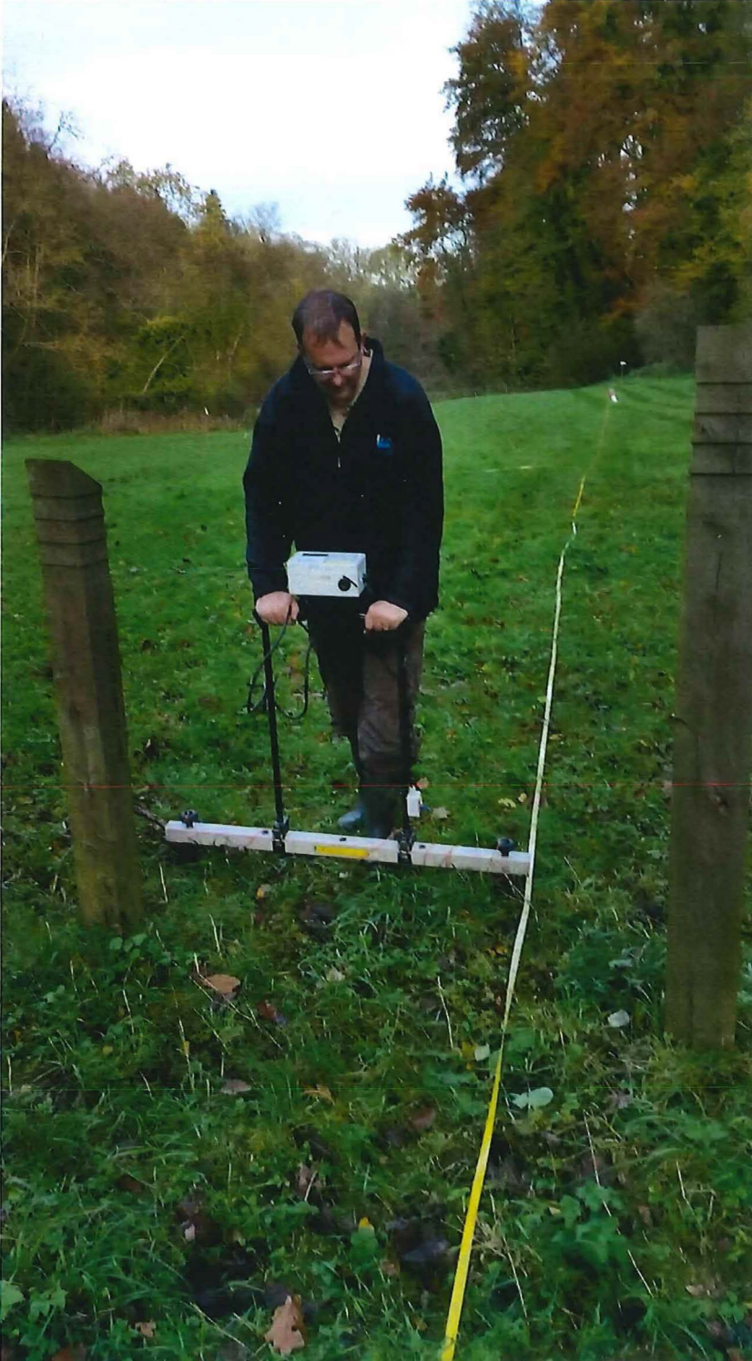
Foto 8 uitvoeren van de weerstandsmetingen. Op het terrein wordt een grid gespannen met meetlinten die als leidraad dienen om het terrein in regelmatige stroken te onderzoeken. Dergelijke metingen geven een gedetailleerd beeld maar zijn arbeidsintensief. Iedere meter wordt het toestel met pinnen in de grond geduwd.
