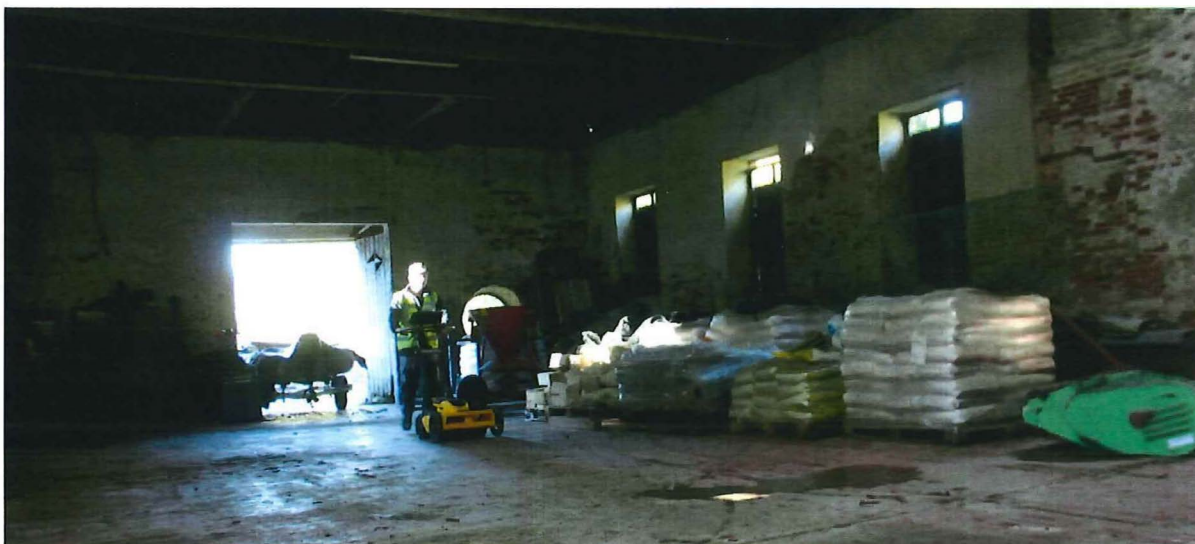
Foto 14 In de kerk zijn radarmetingen verricht. Deze techniek laat toe doorheen de ijzeren bewapening van de recente vloer te meten.
