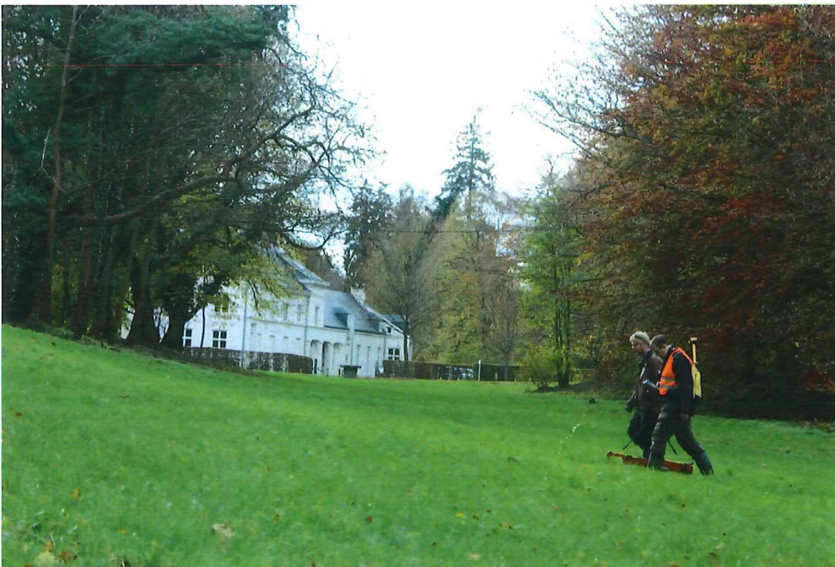
Foto 10 Elektromagnetische metingen gaan snel en dienen om een eerste algemeen beeld van het terrein te bekomen. Het EM toestel wordt net boven het maaVeld gedragen. Een GPS, bevestigd in de gele rugzak, meet automatisch de positie in.
