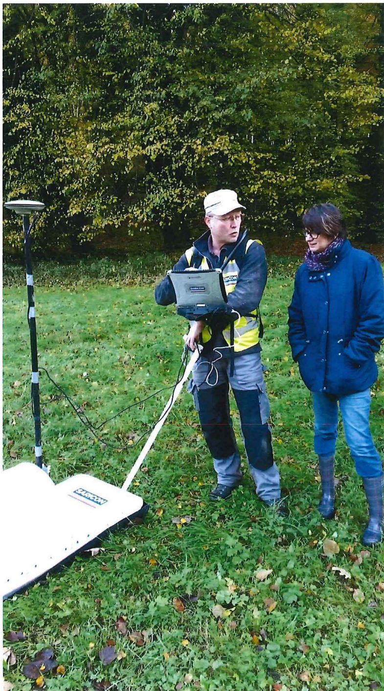
Foto 15 Het terrein rond de kerk werd eveneens onderzocht met behulp van radarmetingen. Op het computerscherm kunnen de meetresultaten gemonitord worden. Een GPS meet de positie automatisch in.
