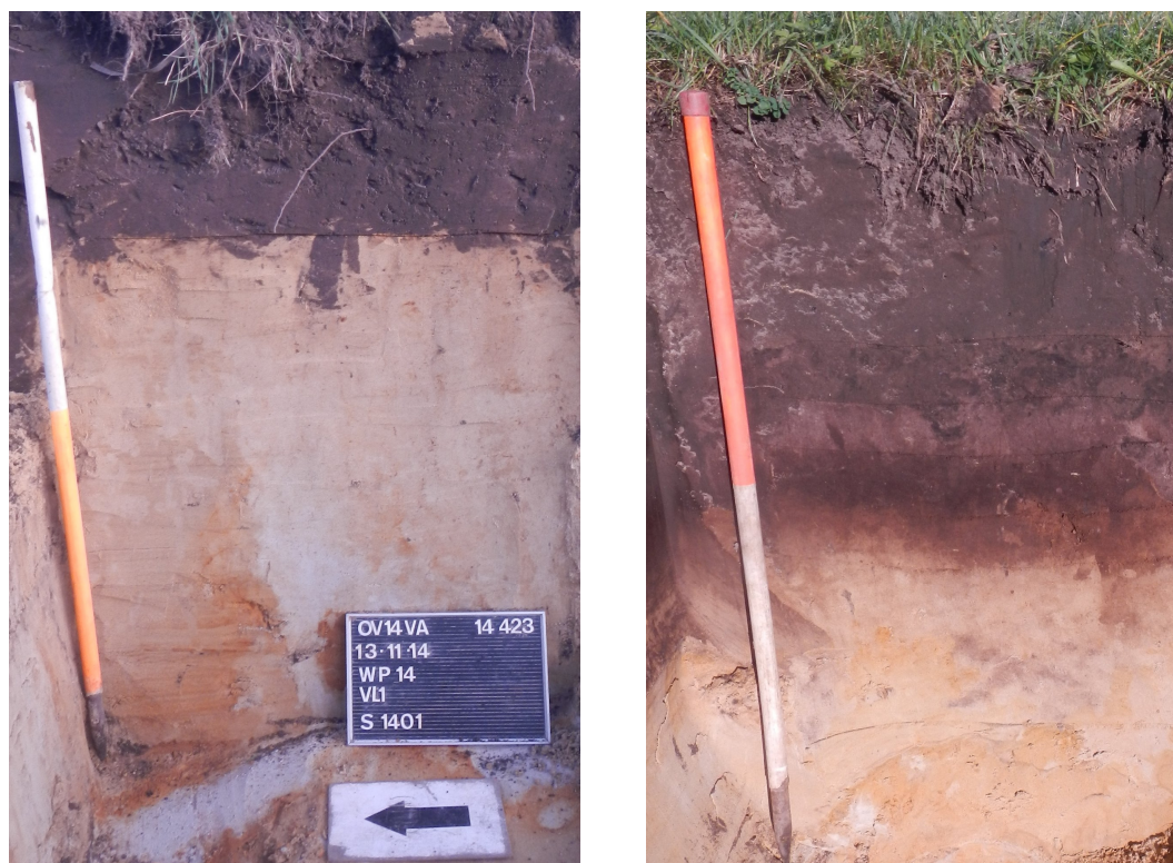
Afbeelding 6.1: Links: Profiel 14 een Ap-C profiel. De bouwvoor is zeer sterk afgelijnd in de C-horizont. Rechts: Profiel 10 een profiel waar de podzolbodest ontwikkeling duidelijk waarneembaar is. Het loodzandkarakter van de E-horizont is verborgen.
