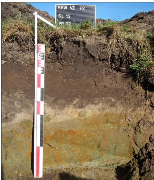
Fig. 11 : Veldopname profiel SL32 PR13 met hoge ligging tertiair substraat.
