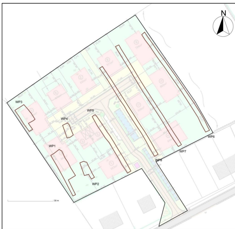
Figuur 20: Inplanting proefsleuven en kijkvensters binnen het plangebied
