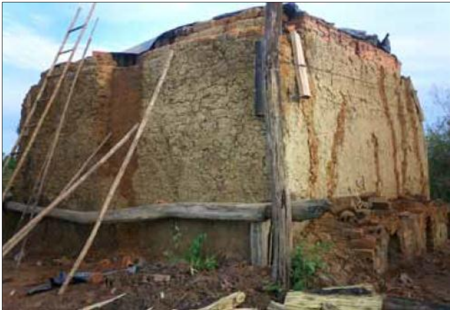
Figuur 33. Voorbeeld van een hedendaagse baksteenoven zonder vaste muren uit Boliviaë, met rechts de overwelfde stookgangen (HARTOCH 2009, 63)
