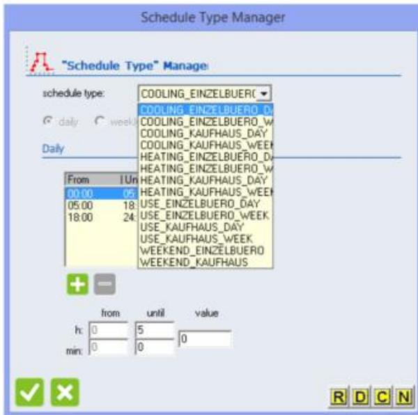
Bild 6. Übersicht der im BIM-Modell hinterlegten Schedule-Types, die in TRNBuild zur Auswahl stehen
