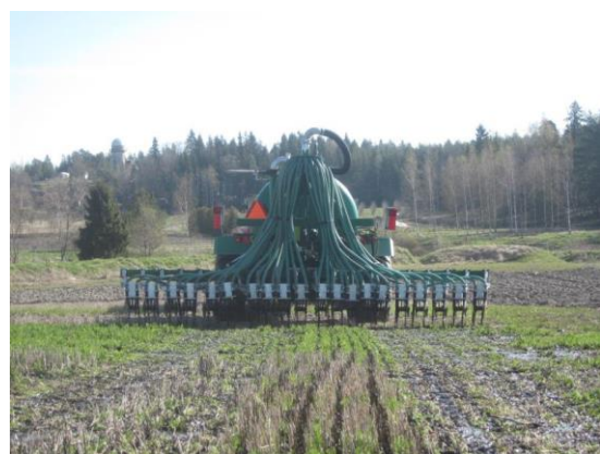
Kuva 4. Biokaasulaitoksen kuivajakeen levitystä Tuorlassa esittelykenttää perustettaessa. Satovuosina rejektiveiä levitettiin pintaan kiekkomultaimelle letkulevityksen tyyppisesti. Ylistarossa orgaanisena lannoitteena käytettiin sian lietelantaa ja separoitua sian lietelantaa.
