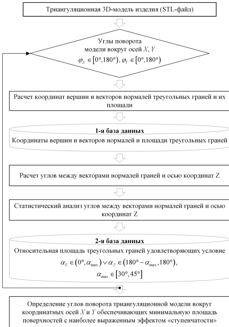
Рисунок 3 – Алгоритм определения углов поворота 3D-модели изделия для его рациональной ориентации в области послыонного построения
