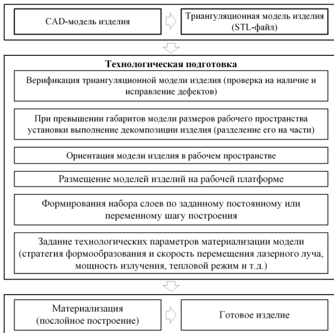
Рисунок 1 – Этапы технологической подготовки изготовления изделий с использованием аддитивных технологий
