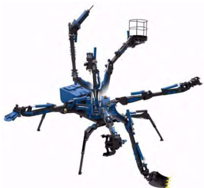
Рис. 5. Роботизированный комплекс (РК) «РОИН» Р-300
