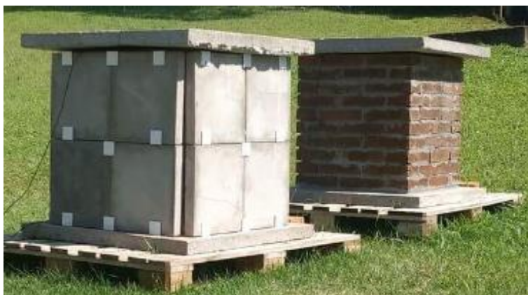
Figura 24 – Protótipos sem o sistema de isolamento térmico na cobertura
