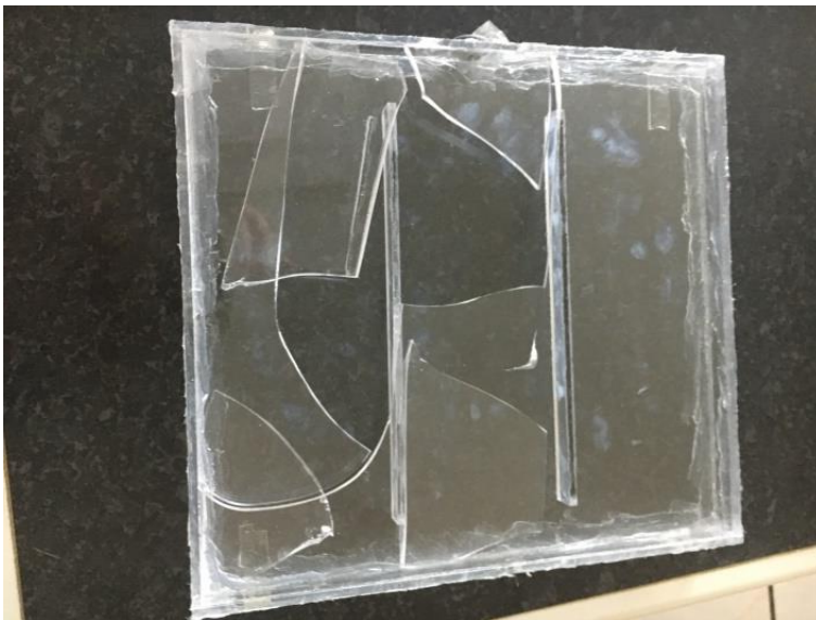
Figura 17 – Excesso de pressão interna na caixa de acrílico
