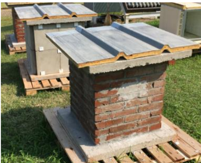
Figura 23 – Protótipos com o sistema de isolamento térmico na cobertura
