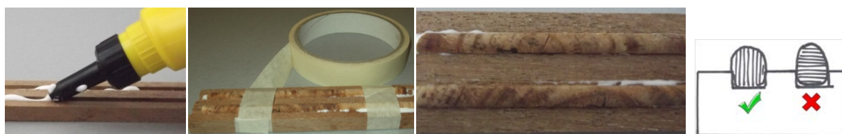
Figura 6. Montaje de testigos en las tablillas (izquierda). Correcta colocación de los testigos con la sección transversal hacia arriba e ilustración de la dirección de las fibras (derecha).
