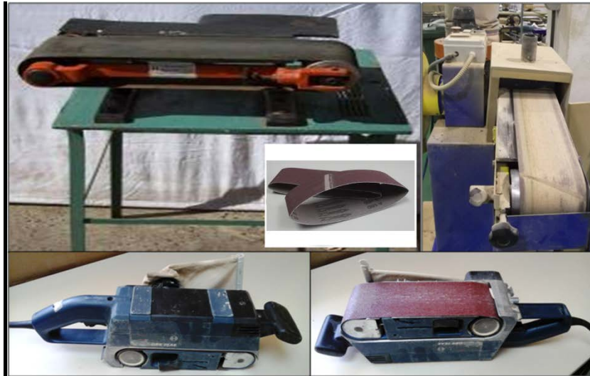
Figura 7. Lijadoras de banda de mesa (arriba) y de mano (abajo). En el centro: papel de lija utilizado en lijadoras de banda.
