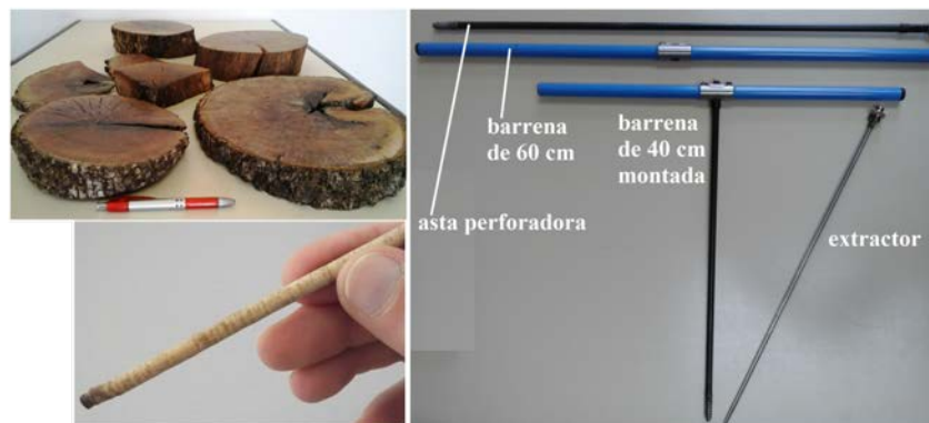
Figura 1. Rodajas de encina, testigo de pino piñonero y barrena forestal.
