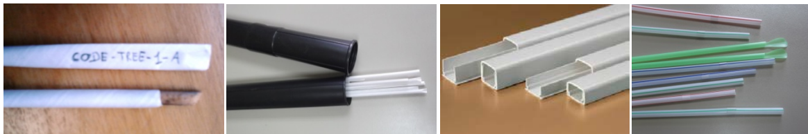
Figura 4. Pajitas de papel y tubo para guardar los testigos (izquierda). Canaletas y pajitas de plástico (derecha).
