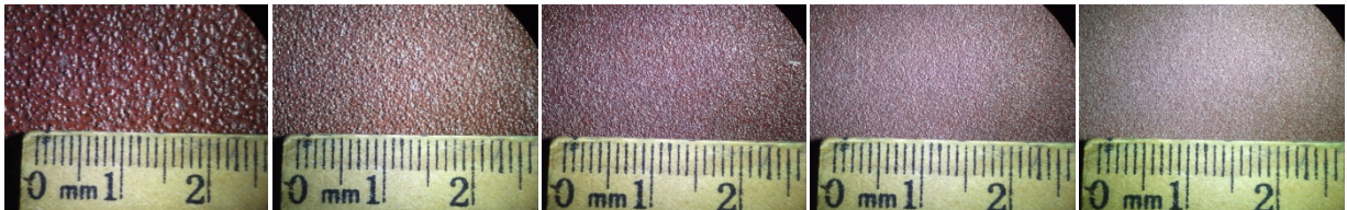
Figura 9. Fotografías de lijas con diversos granos tomadas en el ocular de un estereomicroscopio (aumento 30x). Granos de izquierda a derecha: 60, 120, 150, 220, 320.
