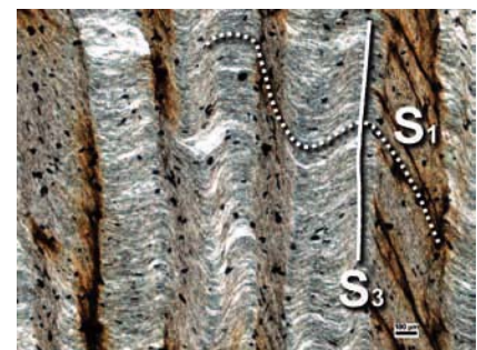
Fig. 3.- Microfotografía de las Pizarras de La Bastida mostrando el divaje de crenulación (S 3 ) deformando al pizarroso regional (S 1 ).
