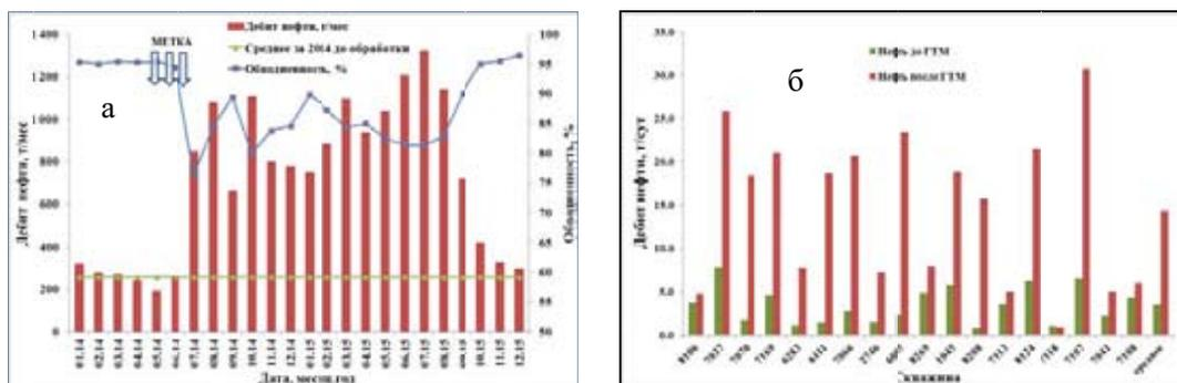
Рис. 3. Результаты работ по ограничению водопритока и увеличению нефтеотдачи на пермо-карбоневой залежи Усинского месторождения с применением композиций: МЕТКА® (а) – суммарно по пяти добывающим скважинам, увеличение дебитов по нефти, снижение обводненности; ГАЛКА® (б) – промышленное использование технологии в 2017 г., прирост среднемесячного дебита нефти по добывающим скважинам после геолого-технических мероприятий (ГТМ) – пароциклической обработки с композицией ГАЛКА®
