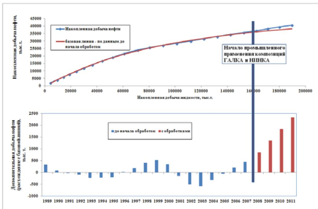
Рис. 8. Анализ эффективности промышленного применения в 2008-2011 гг. технологий повышения нефтеотдачи на Усинском месторождении: увеличение добычи нефти в добывающих скважинах в результате закачки композиций ГАЛКА®-С и НИНКА® в 41 паронагнетательную скважину
