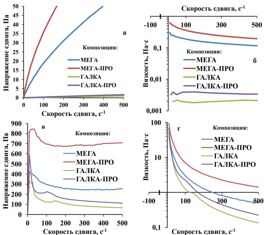
Рис. 5. Реологические кривые течения (а, в) и зависимости вязкости (б, г) растворов различных композиций от скорости сдвига до термостатирования (а, б) и после образования геля при температуре 150 °С (в, г)
