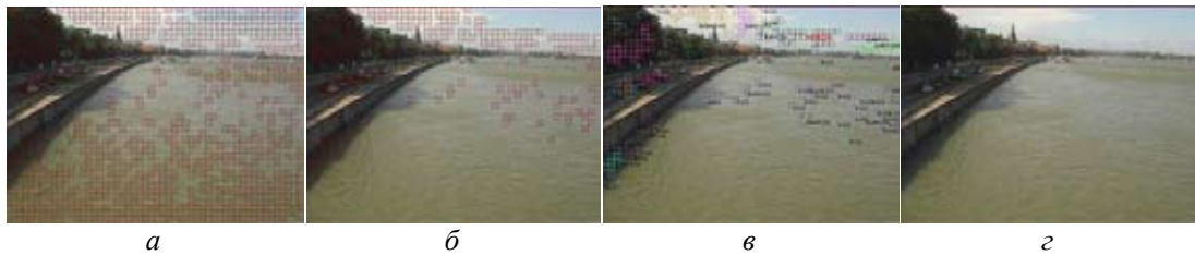
Рис. 3. Этапы работы алгоритма обнаружения дыма для видеопоследовательности http://dyntex.univ-lr.fr/Dyntex/571b210 (кадр 56) с параметрами алгоритма: Blk = 15 , T = 20 , Rate = 1 : a – все движение в кадре; б – серое движение в кадре; в – расчет турбулентности; г – выделенный дым
