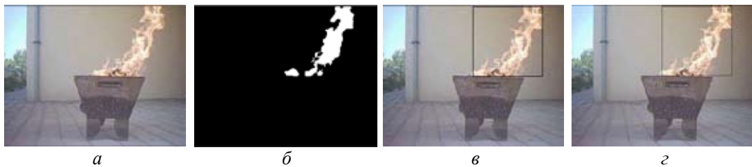
Рис. 4. Этапы работы алгоритма обнаружения пламени для видеопоследовательности http://signal.ee.bilkent.edu.tr/VisiFire/Demo/FireClips/Bilkent/barbeq (кадр 267): a – обработка оригинального видео; б – маска цвета пламени; в – поиск движения цвета пламени; г – выделенное пламя
