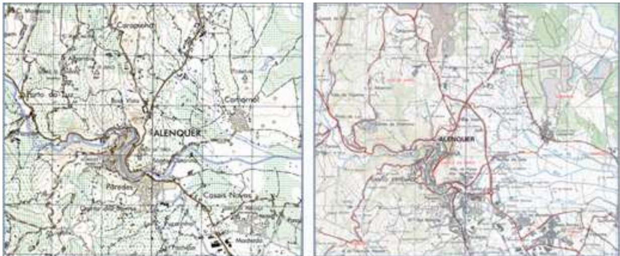
Figura 1: Exemplo de Generalização Cartográfica, á esquerda o excerto de uma carta 1:25 000 do IGeoE e à direita o excerto de uma carta 1:50 000 executada a partir da primeira pelo mesmo Instituto.
