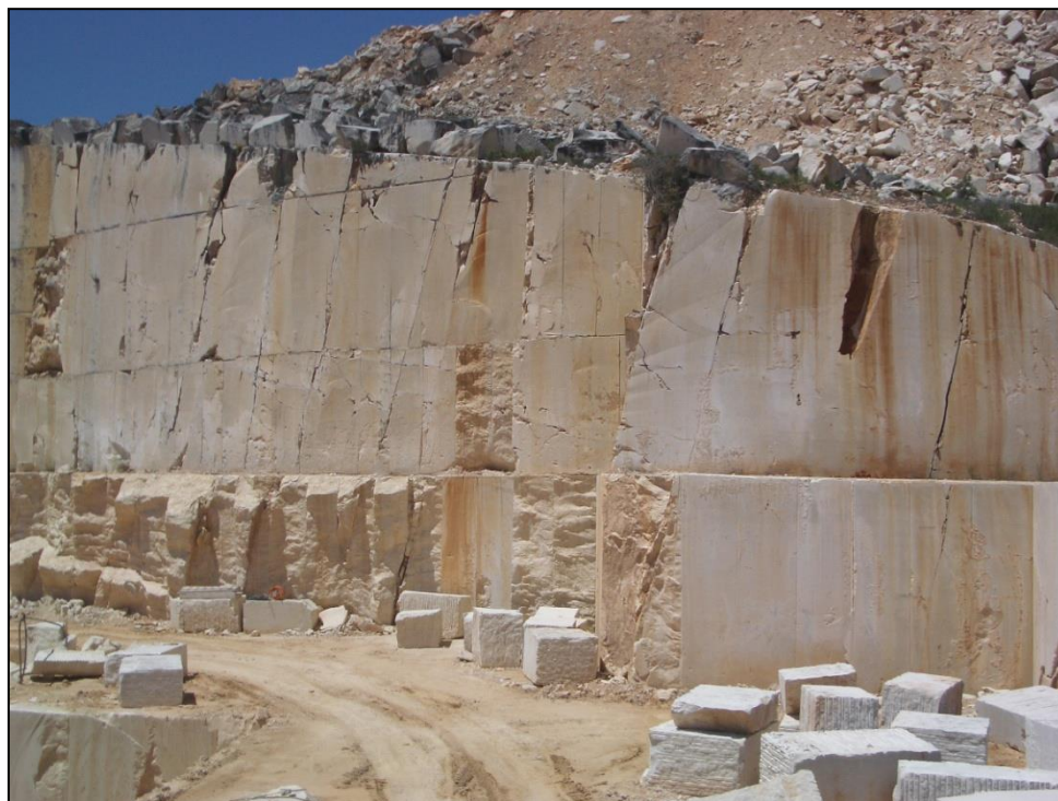
Figura 216- Frente de exploração de calcários ornamentais em Cabeça Veada. A espessura das bancadas é indeterminada mas superior a 15 m. Uma família de diaclases WSW-ENE apresenta espaçamento na ordem dos 3m .
