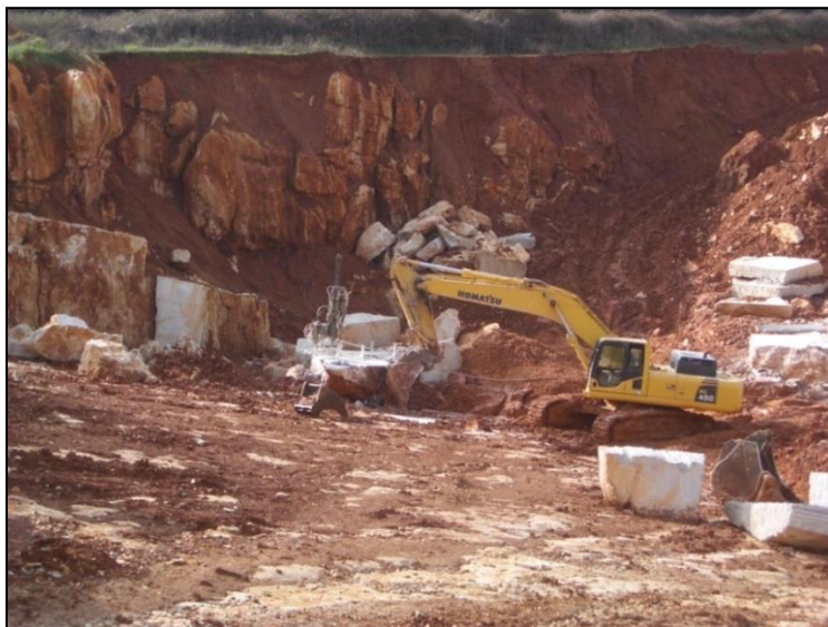
Figura 50- Pedreira na região de Ataíja, a sul de Ponto 29, mostrando carso preenchido por depósito areno-conglomerático inconsolidado, argiloso e ferruginoso.
