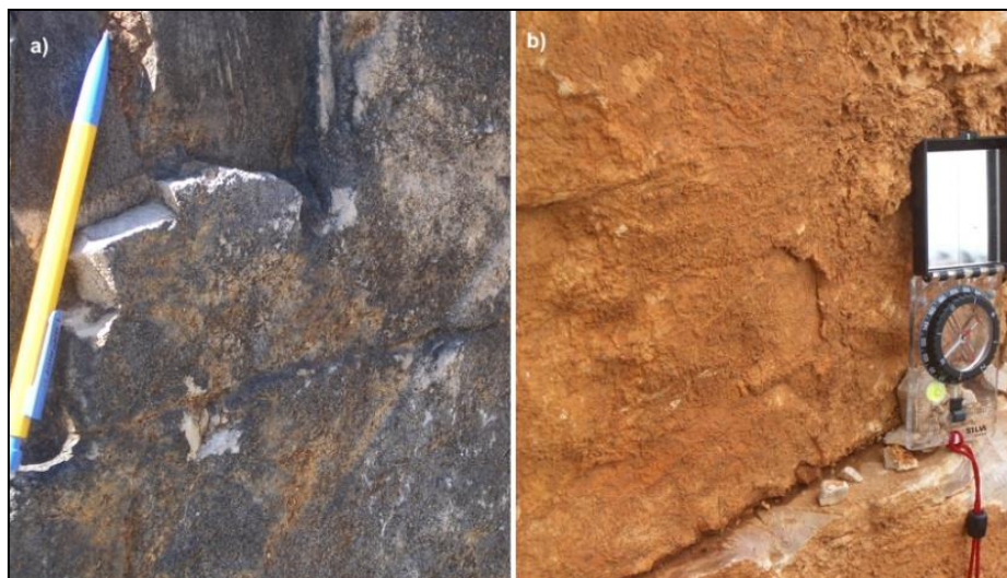
Figura 150- Superfícies planares, pouco rugosas mas cobertas por incrustações finas de cristais de calcite e de óxidos e hidróxidos de manganês e ferro.
