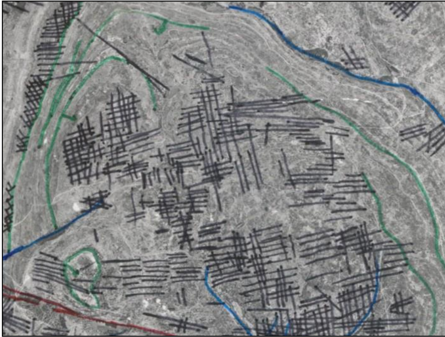
Figura 106- Extrato da fotografia aérea da figura anterior à escala original (aprox. 1/26000). As anotações referem-se a fraturas (traços a negro), fraturas identificadas como falhas (traços a vermelho), lineamentos (a azul) e limites de bancadas com indicação do sentido da inclinação (a verde).
