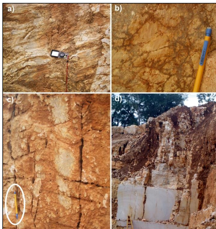
Figura 154- Exemplos ilustrativos de fraturas consideradas diaclases reativadas. a) plano estriado, b) e c) planos polidos, d) fraturas subverticais, com indícios de movimento cisalhante, mas limitadas a estratos sedimentares específicos.
