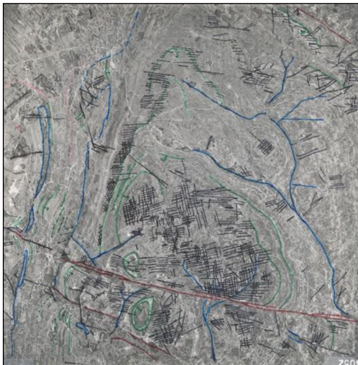
Figura 105- Exemplar de uma das fotografias aéreas do MCE utilizadas. As anotações foram realizadas sobre uma película de acetato transparente sobreposta à fotografia. Cor azul refere-se a linhas de água e outros lineamentos, a cor verde refere-se ao traço da estratificação, a cor preta refere-se a fraturas e a cor vermelha refere-se a falhas (a imagem está redimensionada).
