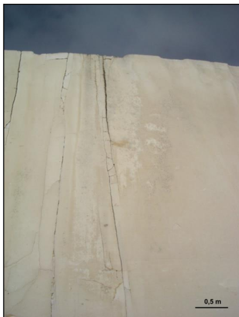
Figura 184- Diaclases em frente de exploração de calcários ornamentais (Formação de Sto. António - Candeeiros, membro de Moleanos, Serra dos Candeeiros). Na zona de justaposição das diaclases verticais desenvolvem-se diaclases sub-horizontais, denunciando que a instalação do sistema terá ocorrido por efeito de soerguimento.
