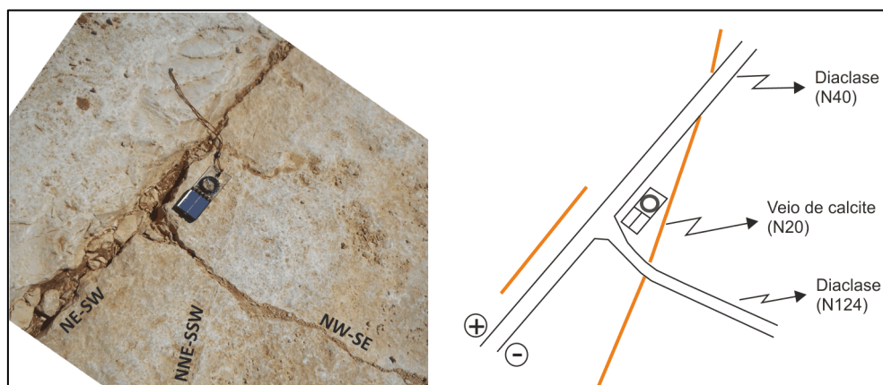
Figura 196- Relações de antiguidade na estação 44. Diaclase NW-SE é posterior a veio NNE-SSW, pois corta-o, mas é anterior a diaclase reativada NE-SW porque roda de modo a estabelecer relação de perpendicularidade. A reativação da diaclase NE-SW é posterior aos veios NNE-SSW.
