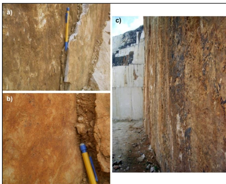
Figura 156- Reduzida espessura da caixa de falha relativamente à extensão do plano de falha como indicador de que se trata de diaclase reativada. a) Material esmagado entre planos de diaclase reativada, b) pormenor de fratura anterior noutra local, c) vista parcial da extensão da fratura.
