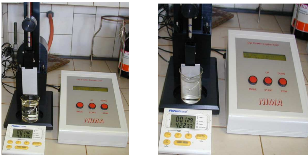
Figura 12 – Fotografias ilustrativas da fase da deposição dos revestimentos híbridos de sol-gel nos provetes de liga de alumínio
