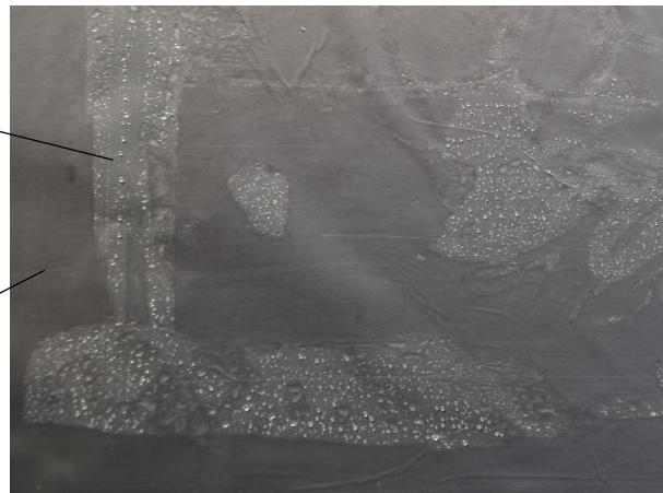
Slika 48: Pravilno pripravljena plošča – na netiskovnih površinah ni vidnih večjih kapljic vode
