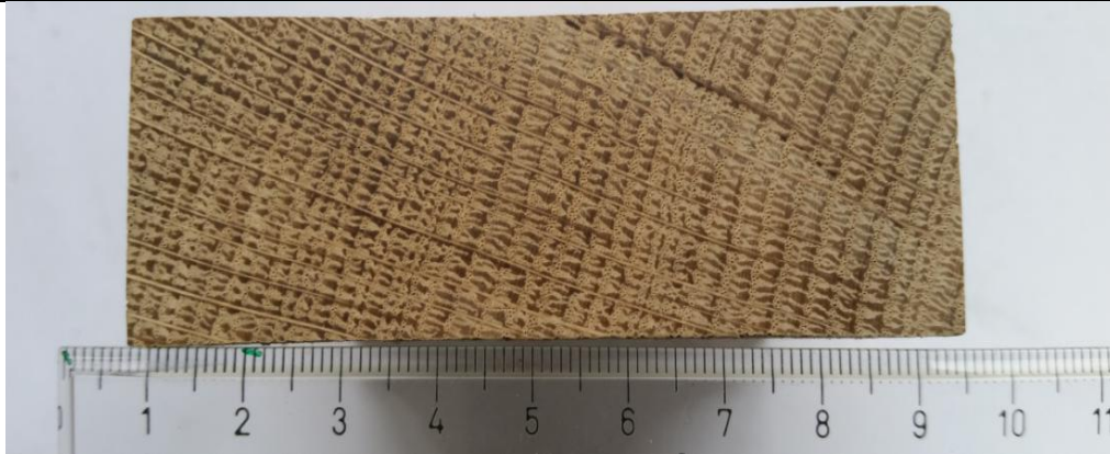
Slika 33. Makrostruktura poprečnog presjeka recentnog hrasta
