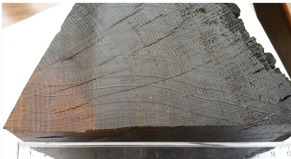
Slika 35. Makrostruktura poprečnog presjeka drva hrasta starosti 5800. Godina
