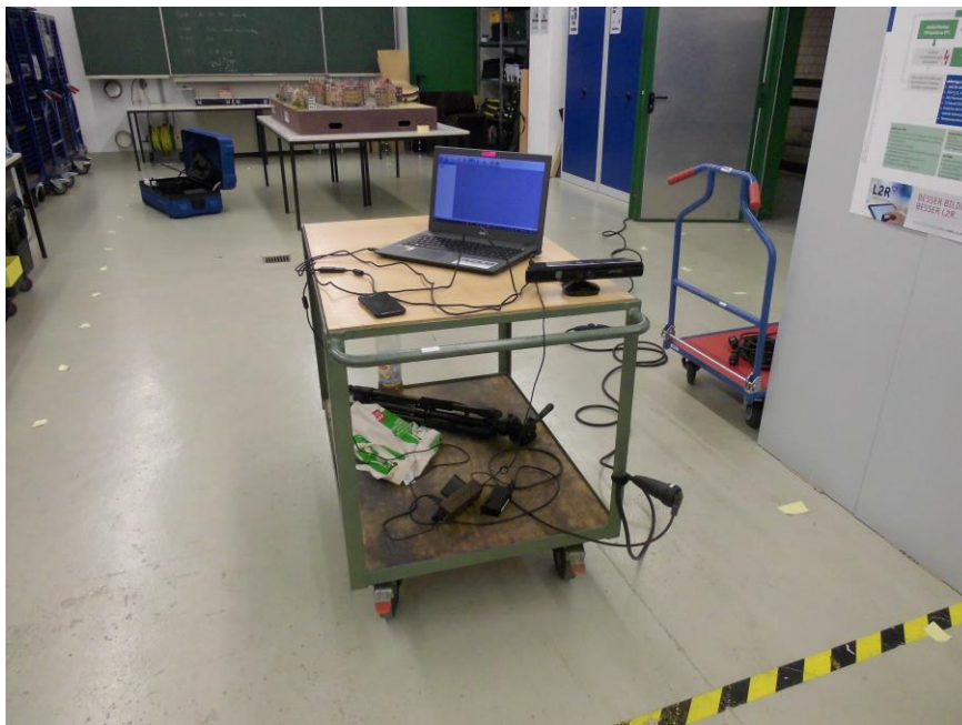
Abbildung 12: Rollwagen mit Computer, Kinect Sensor und Stromversorgung
