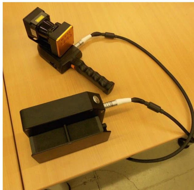
Abbildung 3: GeoSLAM ZEB-REVO Handscanner mit Datenspeicher
