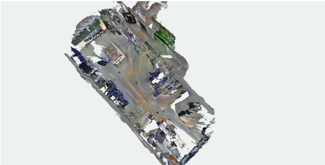
Abbildung 15: 3D Rekonstruktion (Ansicht von seitlich oben) mit tatsächlichem Scanweg (orange) Kinect
