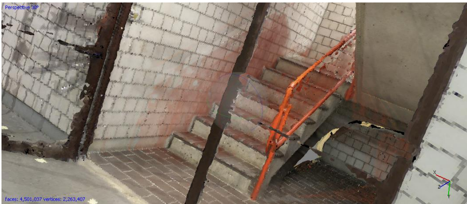
Abbildung 31: Darstellung Treppenhaus in der 3D Rekonstruktion durch Fotogrammetrie
