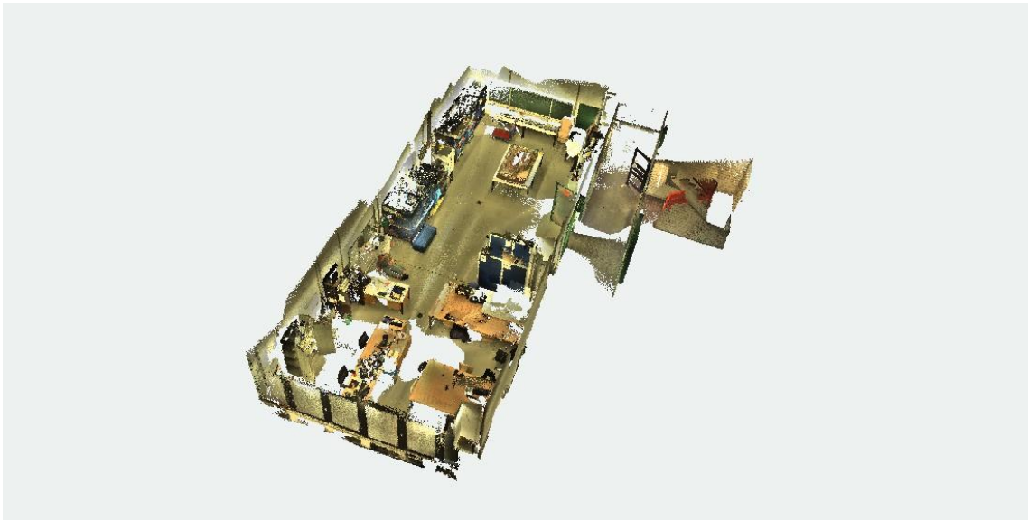
Abbildung 20: 3D Rekonstruktion nach Nachverarbeitung (FARO Freestyle3D + FARO Scene)
