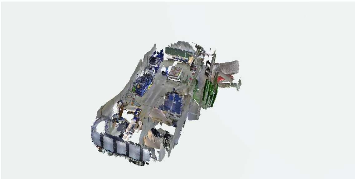
Abbildung 19: 3D Rekonstruktion nach Nachverarbeitung (Microsoft Kinect + FARO Scene)
