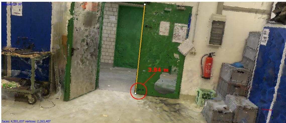
Abbildung 35: Maßangabe Haupteingangstür in 3D Rekonstruktion Fotogrammetrie
