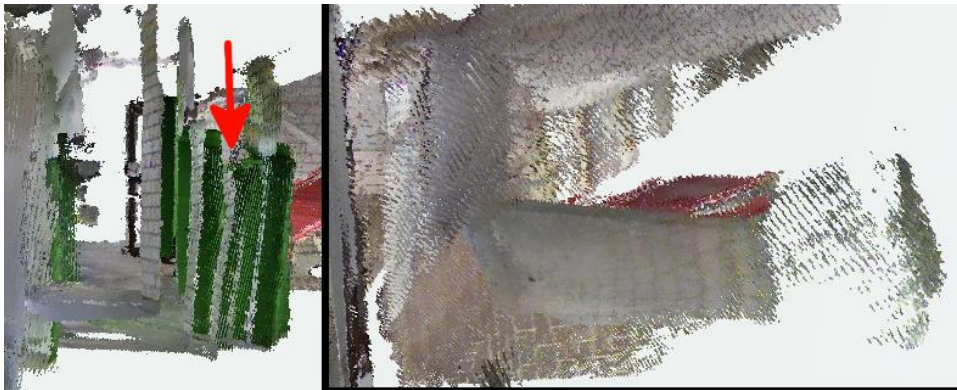
Abbildung 39: Dopplungen an einer Tür (links) und niedrige Auflösung Treppenhaus (rechts) aus Rekonstruktion mit Kinect
