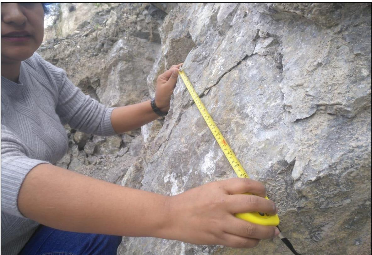
**Figura 19.** Medición de la potencia del estrato.
