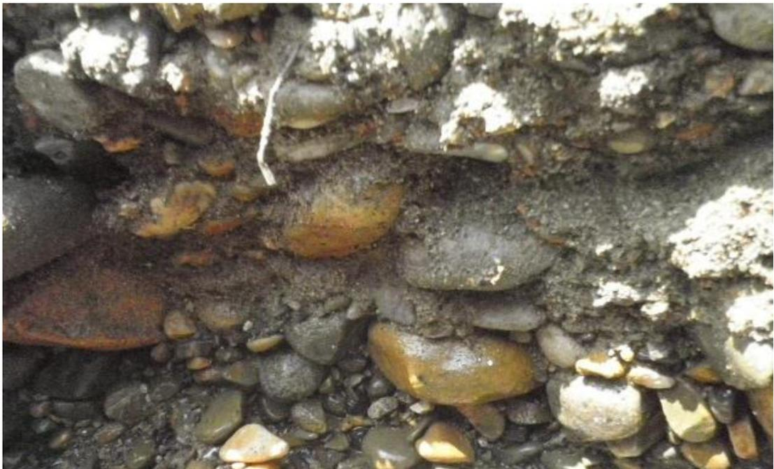
Figura 23. Foto del suelo del río moche de la segunda capa a 1.2 m (Fuente: Elaboración propia)
