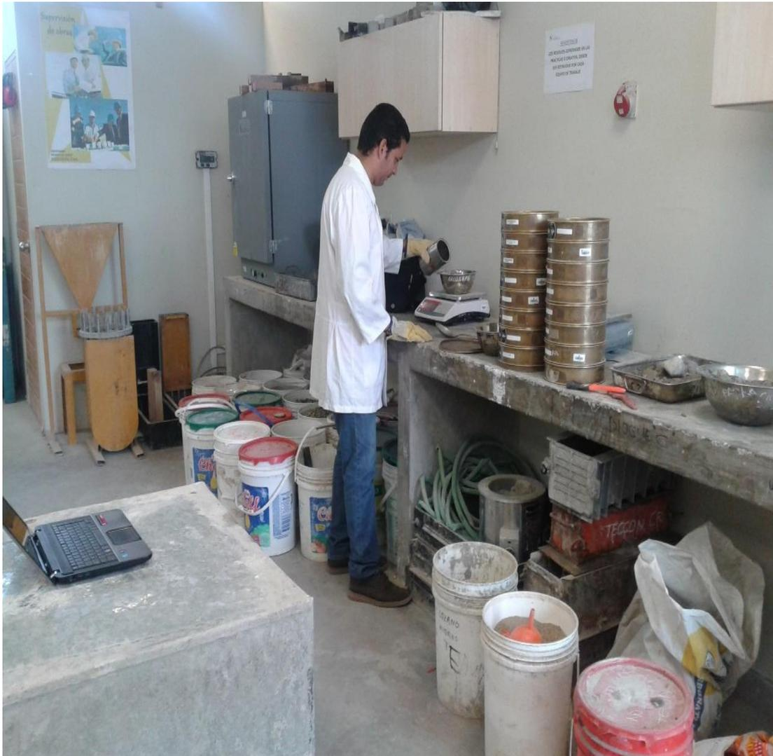
Figura 25. Peso y Tamizado de las muestras en laboratorio (Fuente: Elaboración propia)
