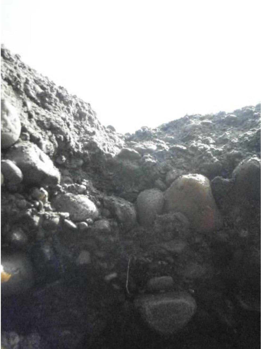
Figura 24. Foto del suelo del rio moche de la segunda capa a 2.3 m (Fuente: Elaboración propia)
