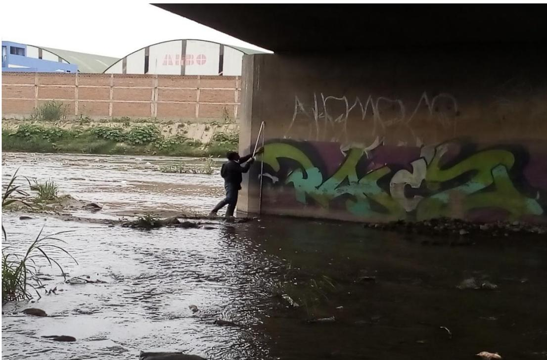
Figura 35. Medición en los pilares del puente y la huella del Tirante que dejó la máxima avenida del mes de marzo durante el fenómeno del niño costero (Fuente: Elaboración propia)
