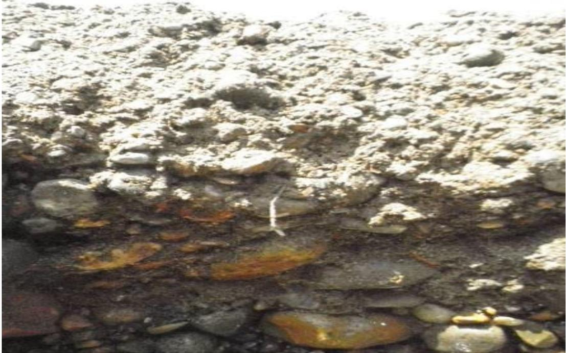
Figura 22. Foto del suelo del río moche de la primera capa a 0.30 m (Fuente: Elaboración propia)
