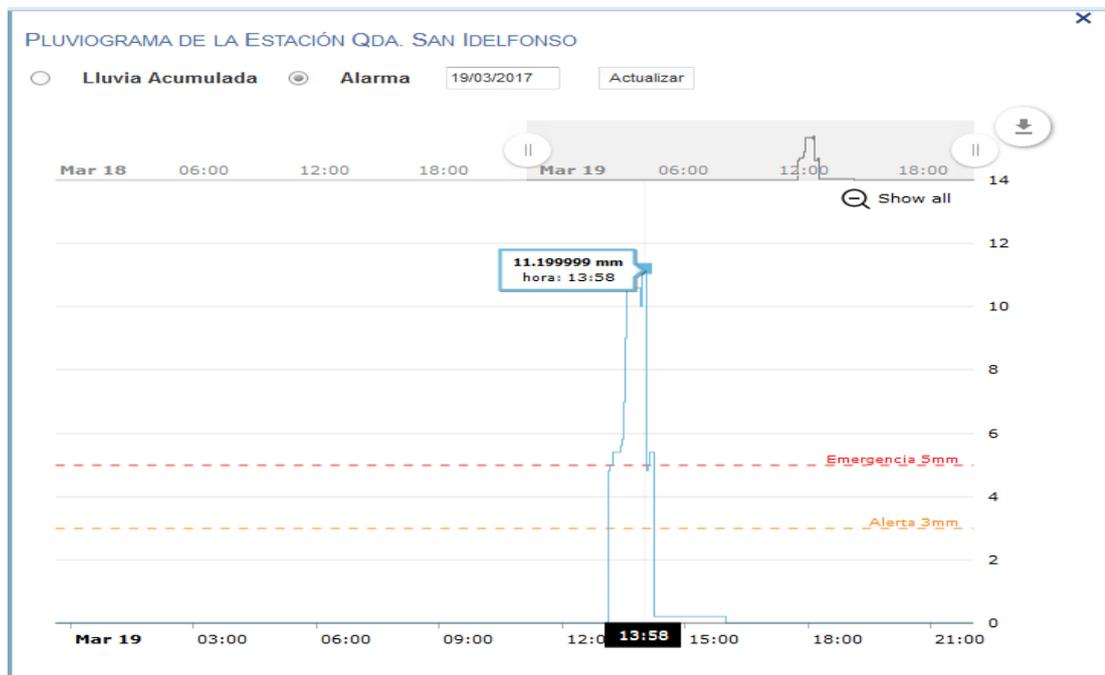
Figura 14. Hietograma de la estación pluviométrica de la quebrada San Idelfonso del día 19/03/2017 (fuente: <http://snirh.ana.gob.pe/visorpluiofen/>)
